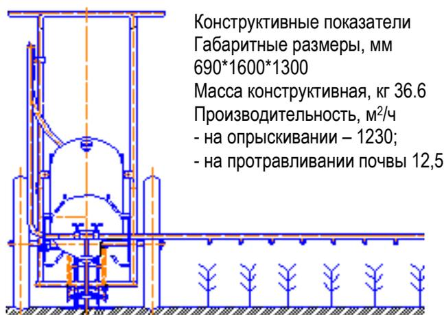
Рис. 1. Чертеж опрыскивателя
