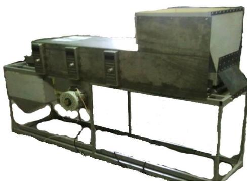
Рис. 7. Экспериментальная технологическая линия с СВЧ-модулем и ИК-излучением
