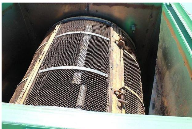
Рис. 5. Сетчатый барабан мобильного сушильного комплекса СУ-1
