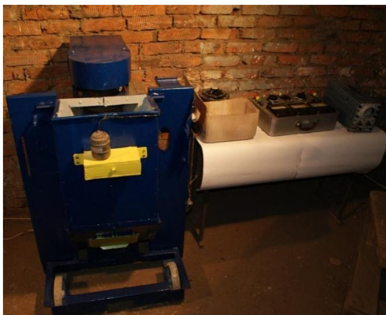
Рис. 2. Внешний вид производственного образца смесителя – обогатителя концентрированных кормов во время проведения экспериментов
