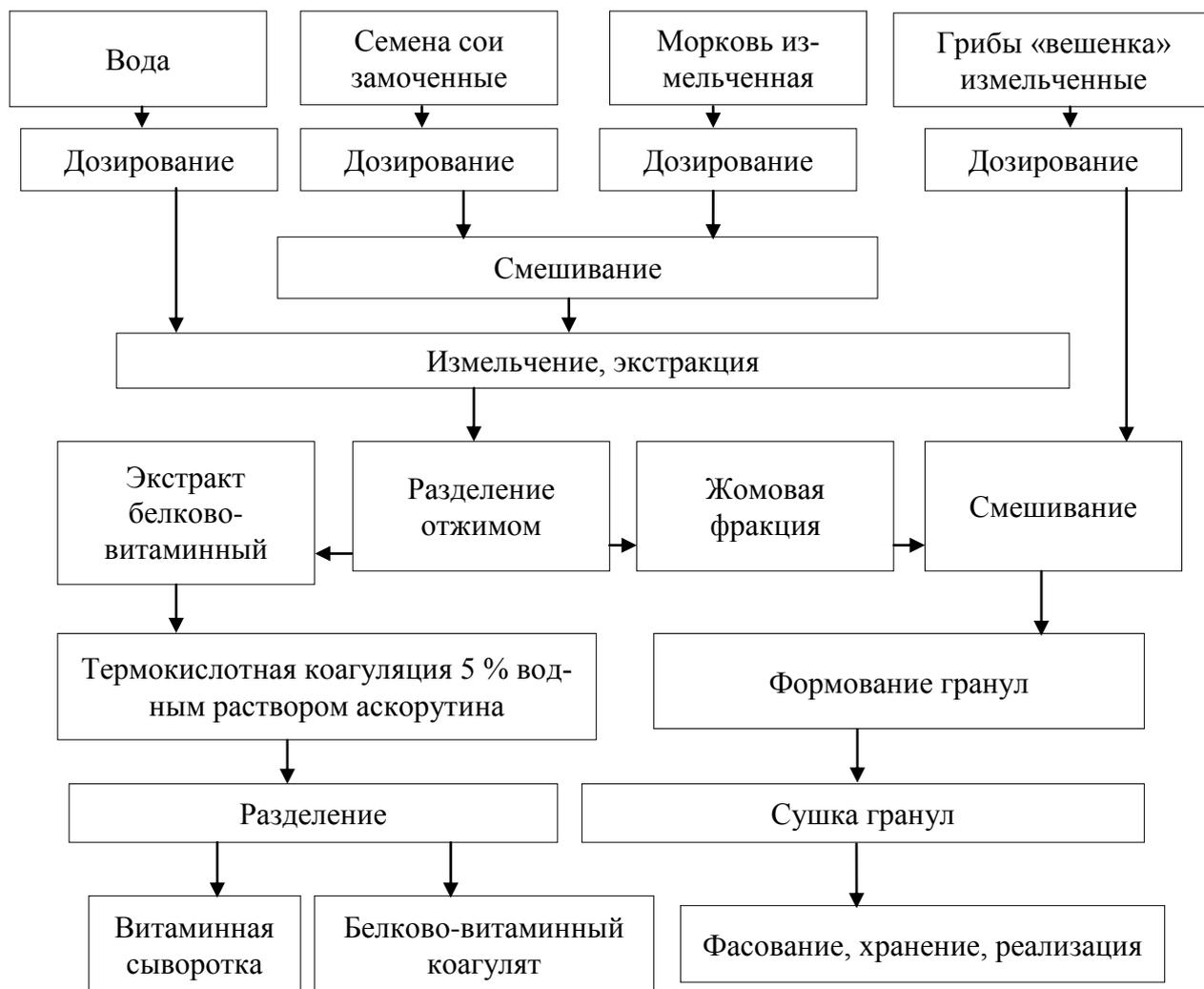
Рис. 2. Принципиальная технологическая схема производства питания на основе соево-морковных композиций
