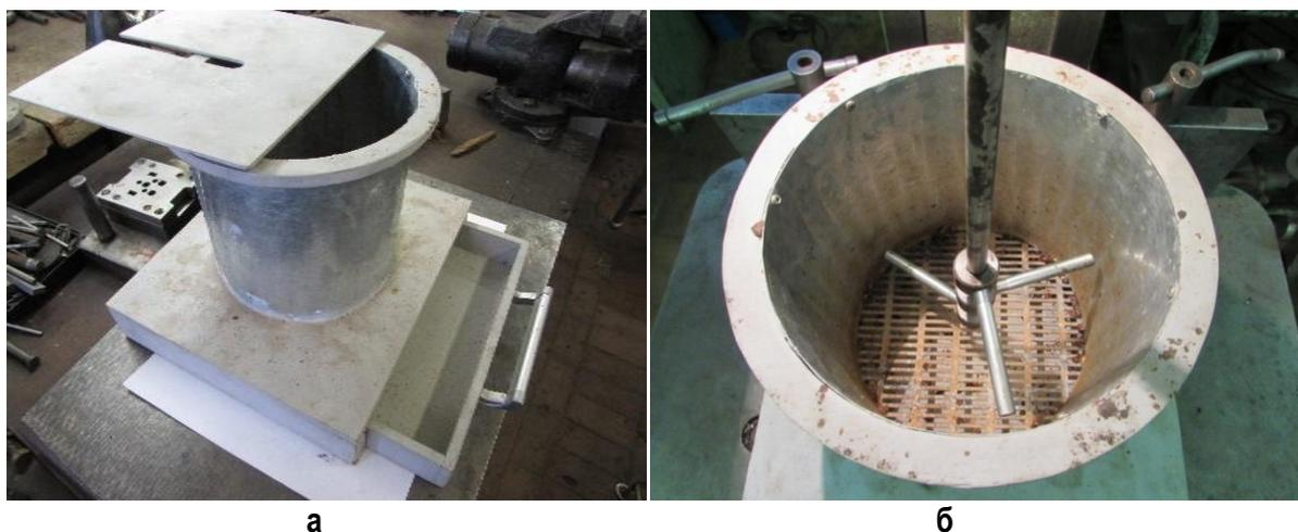
Рис. 2. Лабораторная установка для очистки перговых гранул от органической оболочки: а – общий вид (без рабочего вала); б – рабочая камера с решетом, рабочим валом и установленными на нем штифтами
