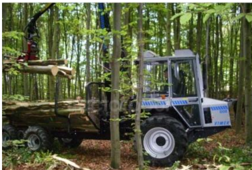
Рис. 2. Сортиментоподборщик налегчайшего класса Vitek 608 с колесной ходовой системой 6К6, массой 2960 кг и мощностью двигателя 18 кВт
