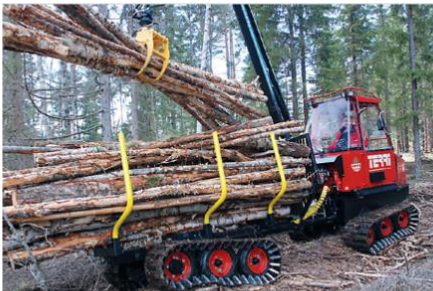
Рис. 1. Сортиментоподборщик налегчайшего класса Terri 34 с траковой ходовой системой, массой 4 900 кг и мощностью двигателя 46 кВт
