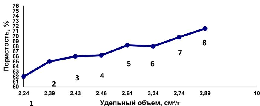
Рис.1. График зависимости пористости изделий от удельного объема:
