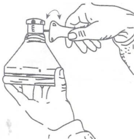
Рисунок 5 – Порядок регулировки жирности сливок
