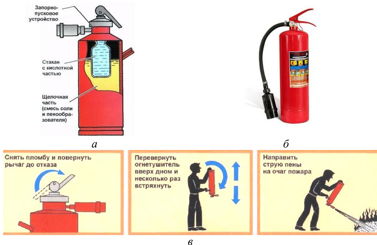
Рис. 3.33. Огнетушители ОХП: а – устройство; б – внешний вид; в – порядок работы
