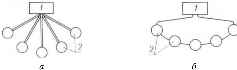
Рис. 3.38. Схема устройства систем электрической пожарной сигнализации: а – лучевая; б – шлейфная; 1 – приемные станции; 2 – извещатели
