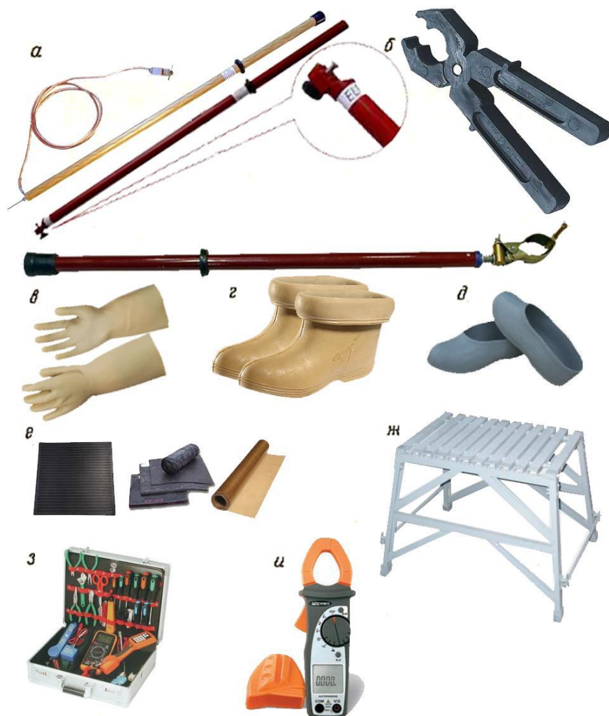
Рис. 3.23. Электрозащитные средства, применяемые в электроустановках: а – изолирующие штанги; б – изолирующие клещи; в – диэлектрические перчатки; г – диэлектрические боты; д – диэлектрические галоши; е – резиновые коврики и дорожки, лакоткань (используется в качестве гибкого электроизоляционного материала в электрических машинах и аппаратах); ж – изолирующая подставка; з – монтерский инструмент с изолированными ручками; и – токоизмерительные клещи
