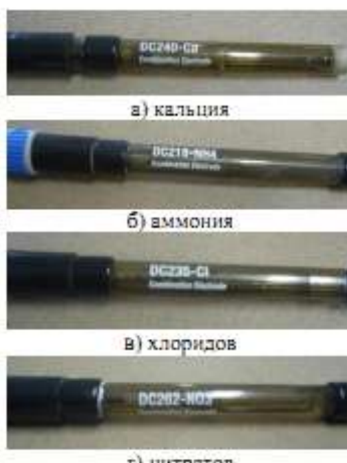
Рис. 27. Ионоселективные электроды: а – кальция; б – аммония; в – хлоридов
