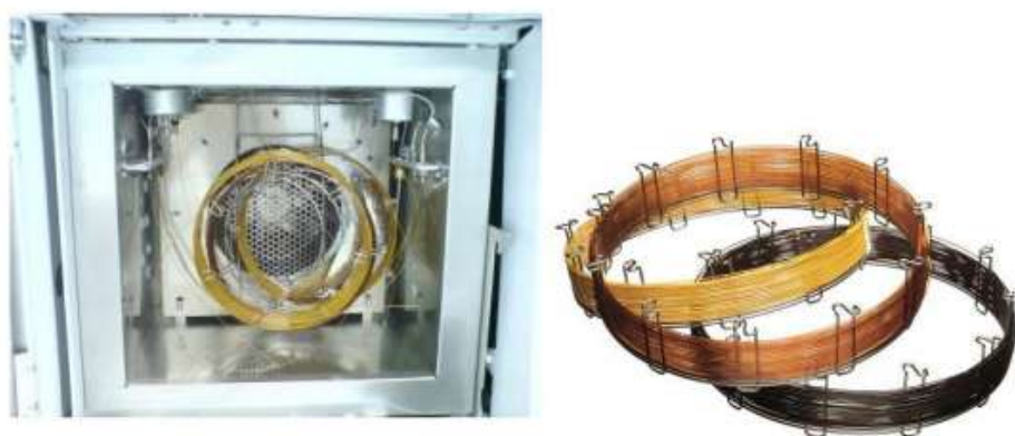
Рис. 37. Капиллярная колонка и ее положение в хроматографе
