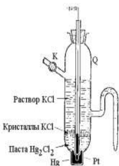
Рис. 25. Устройство каломельного электрода
