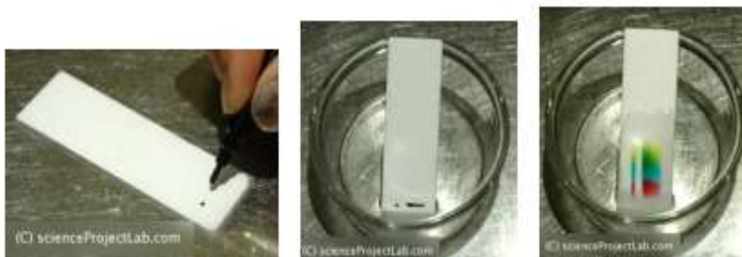
Рис. 53. Техника выполнения планарной хроматографии
