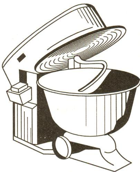
Рисунок 4.8 – Машина тестомесильная Л4-ХТВ
