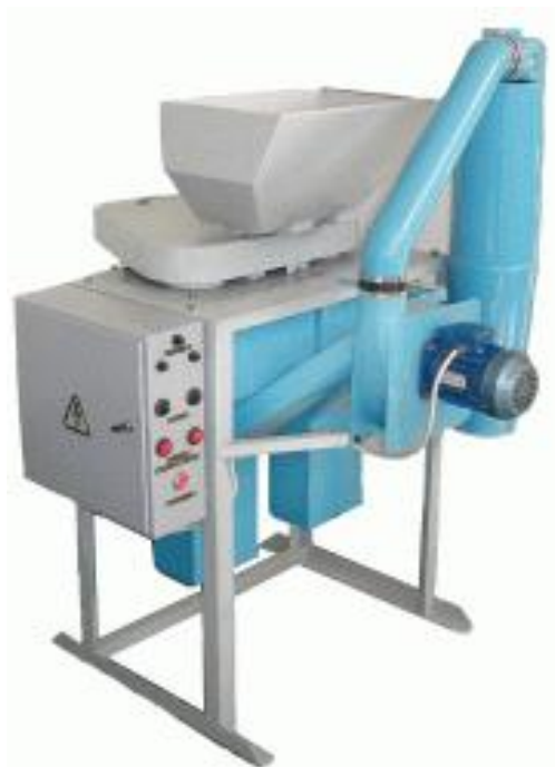
Рисунок 3.6 – Дробильно-крупноотделяющая машина ДКМ-2м: производительность по крупе – 200 кг/ч; мощность: на размол – 5,5 кВт, на аспирацию – 0,37 кВт; габариты: высота – 1,6 м, длина – 1,3 м, ширина – 0,8 м; вес – 180 кг
