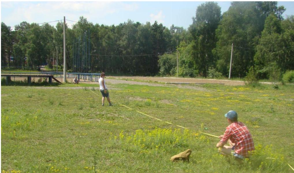
*Рисунок 8 – Контрольный промер четвертой стороны и закрепление вершин квадратов по ней*
