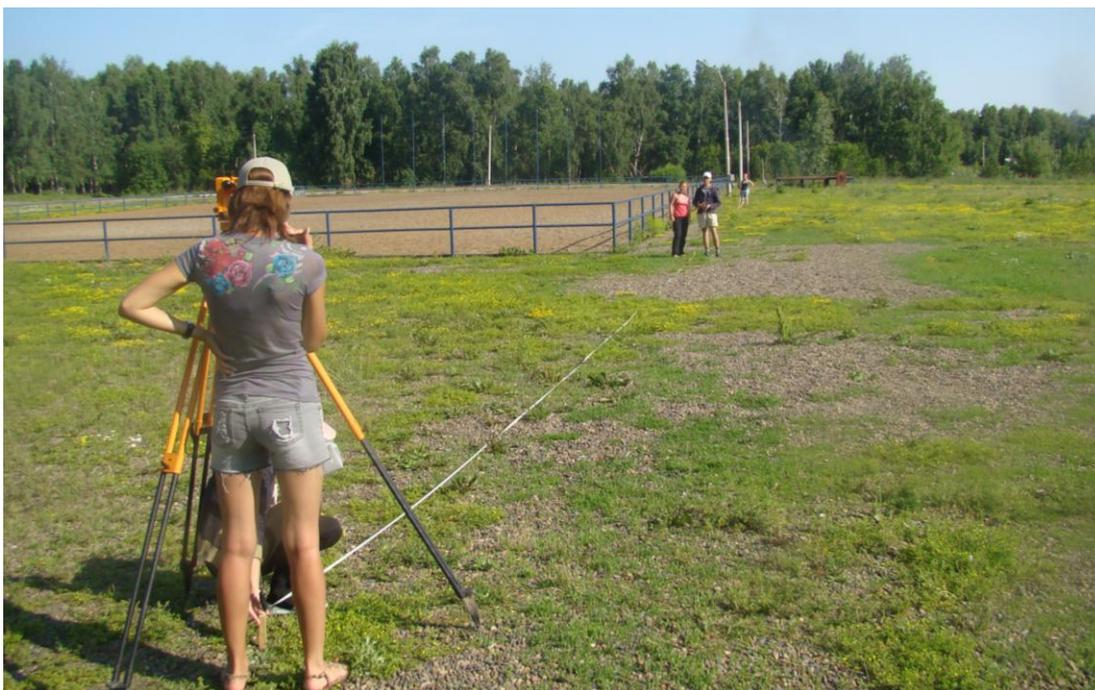
*Рисунок 6 – Разметка базисной линии*
