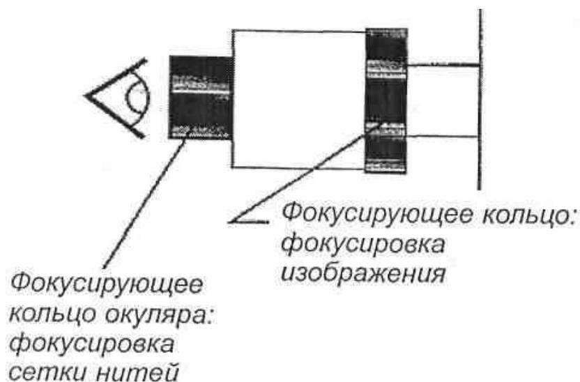
Рисунок 10 – Оптический центрир
