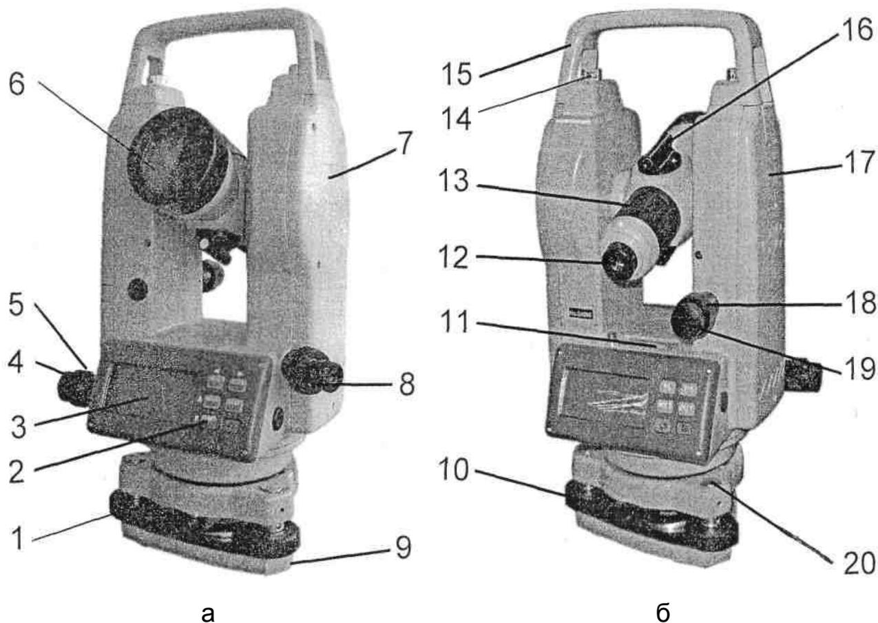
Рисунок 3 – Устройство электронного теодолита VEGA TEO 5:
