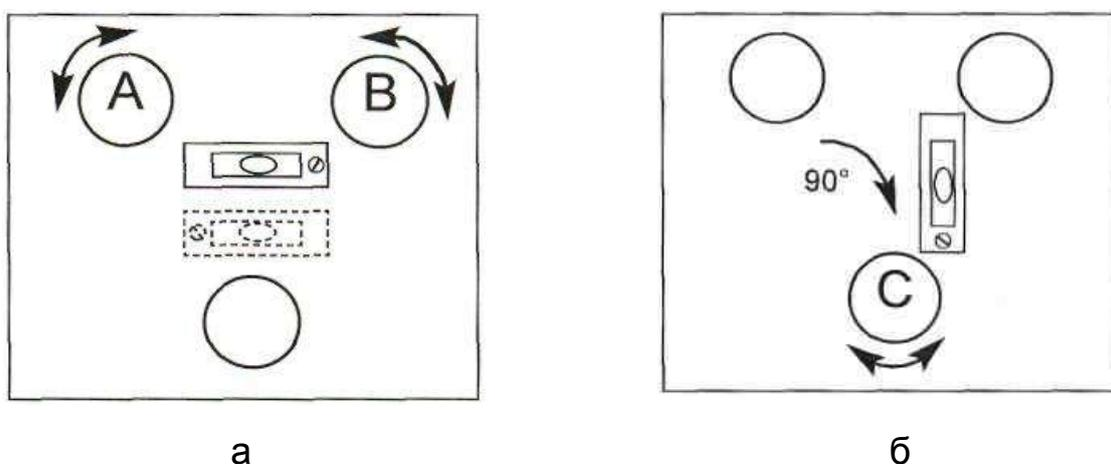
Рисунок 9 – Точное горизонтирование по цилиндрическому уровню
