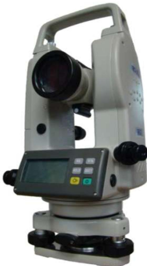
*Рисунок 2 – Электронный теодолит VEGA TEO 5*
