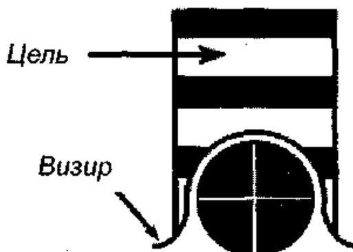
Рисунок 12 – Визирование на цель по коллиматорному визиру
