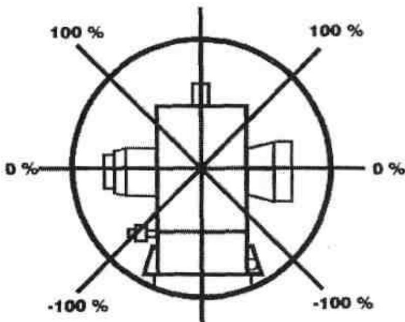
Рисунок 19 – Схема направления счёта величины уклона
