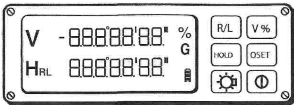
*Рисунок 4 – Внешний вид панели управления электронного теодолита VEGA TEO 5*
