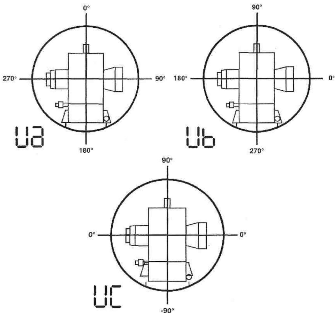
*Рисунок 7 – Возможные системы отсчёта вертикального круга*
