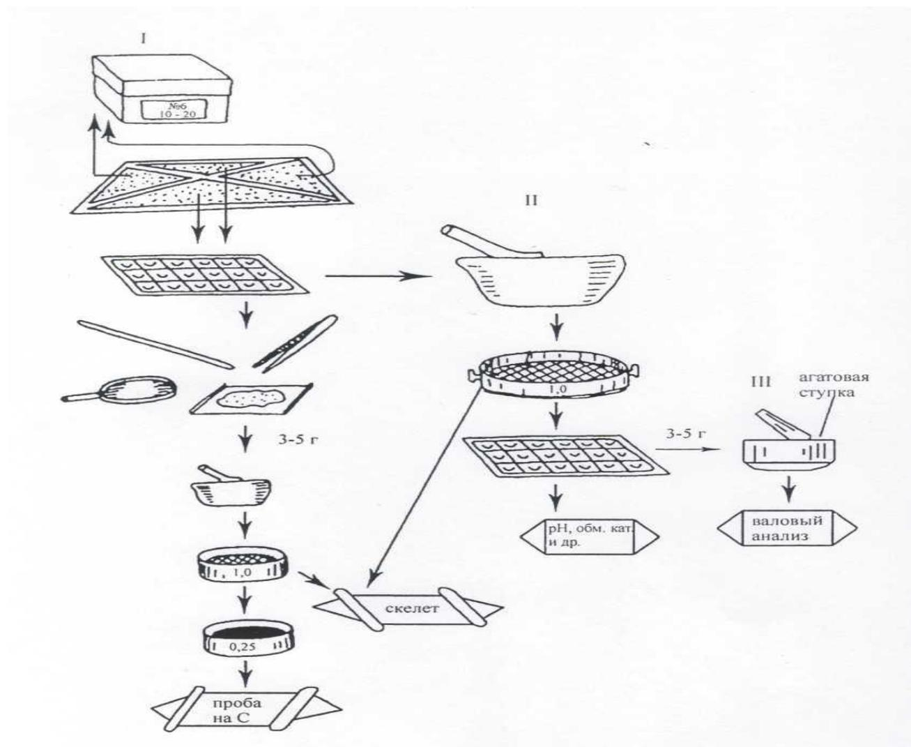
Рис. 1 - Схема подготовки почвенного образца к анализу
