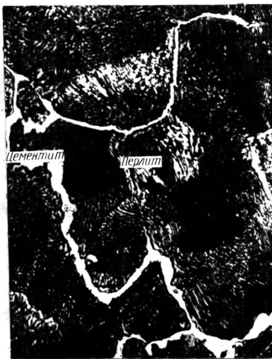
Рис. 35. Микроструктура заэвтектоидной стали (1,2 % С), \times 200
