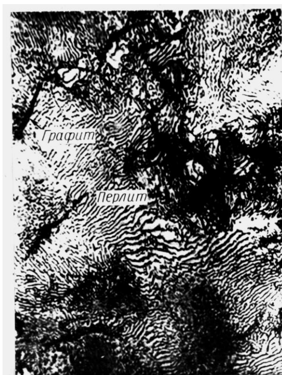
Рис. 39. Микроструктура серого перлитного чугуна, \times 1000
