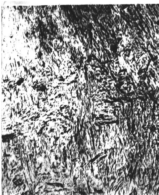
Рис. 44. Микроструктура закаленной стали (мартенсит), \times 500
