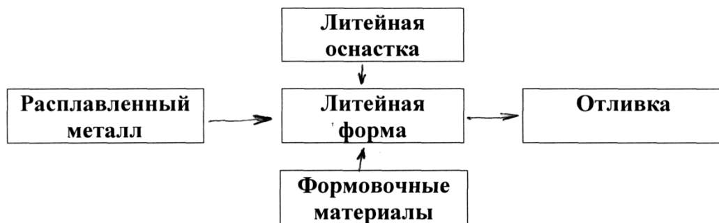
Рис. 50. Схема технологического процесса получения отливок в песчано-глинистые формы
