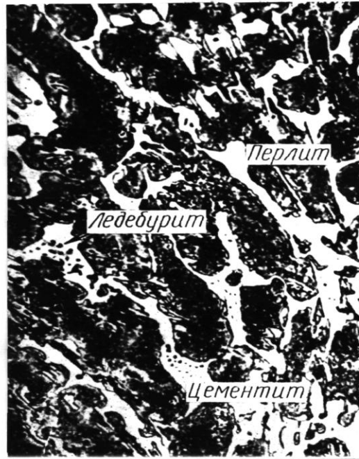
Рис. 36. Микроструктура доэвтектического чугуна, \times 200
