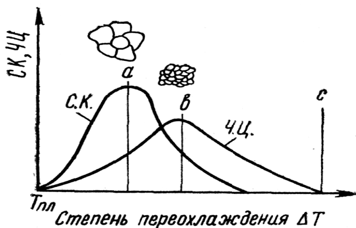
Рис. 10. Зависимость скорости роста кристаллов (с .к.) и скорости зарождения центров кристаллизации (ч. ц.) от степени переохлаждения
