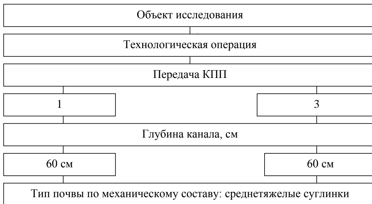
Рисунок 4.1 – Схема проведения опытов при лабораторно-полевых испытаниях МТА
