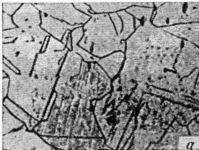
*Рис. 8. Микроструктура стали марки 45X14H14B2M после закалки в воде от 1050...1100 °С, ×500*
