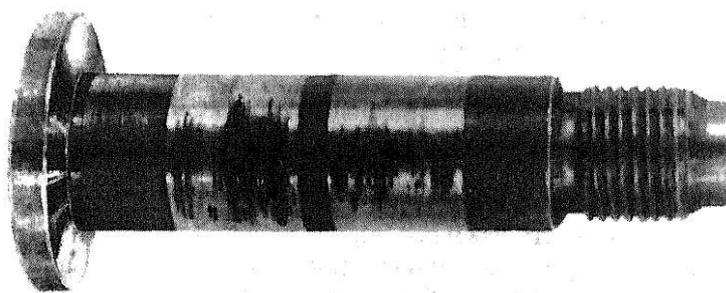
*Рис. 4.8. Болт шарнирного соединения с тонким слоем бронзы*
