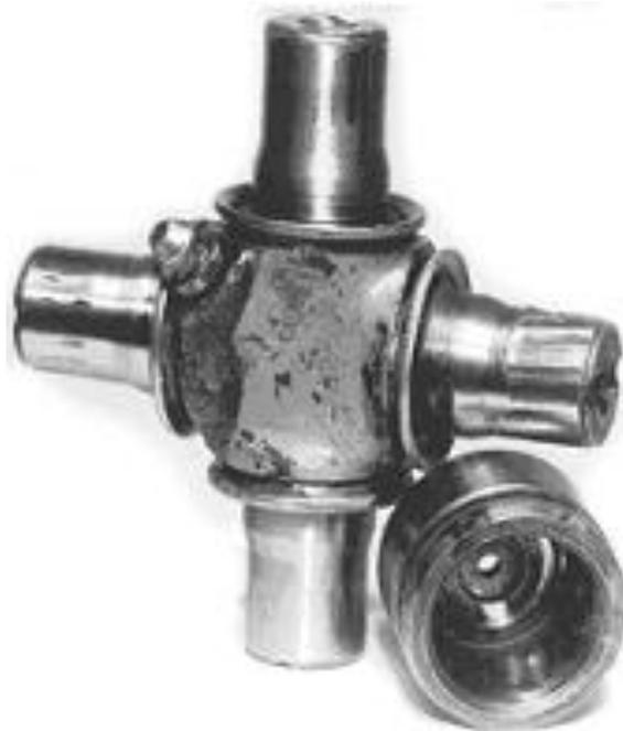
*Рис. 4.6. Разрушение карданного шарнира в виде бринеллирования*
