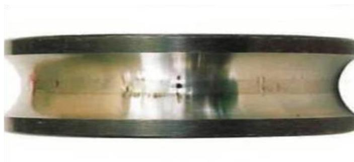
*Рис. 4.5. Бринеллирование на дорожке качения в результате вибрации в неподвижном состоянии*
