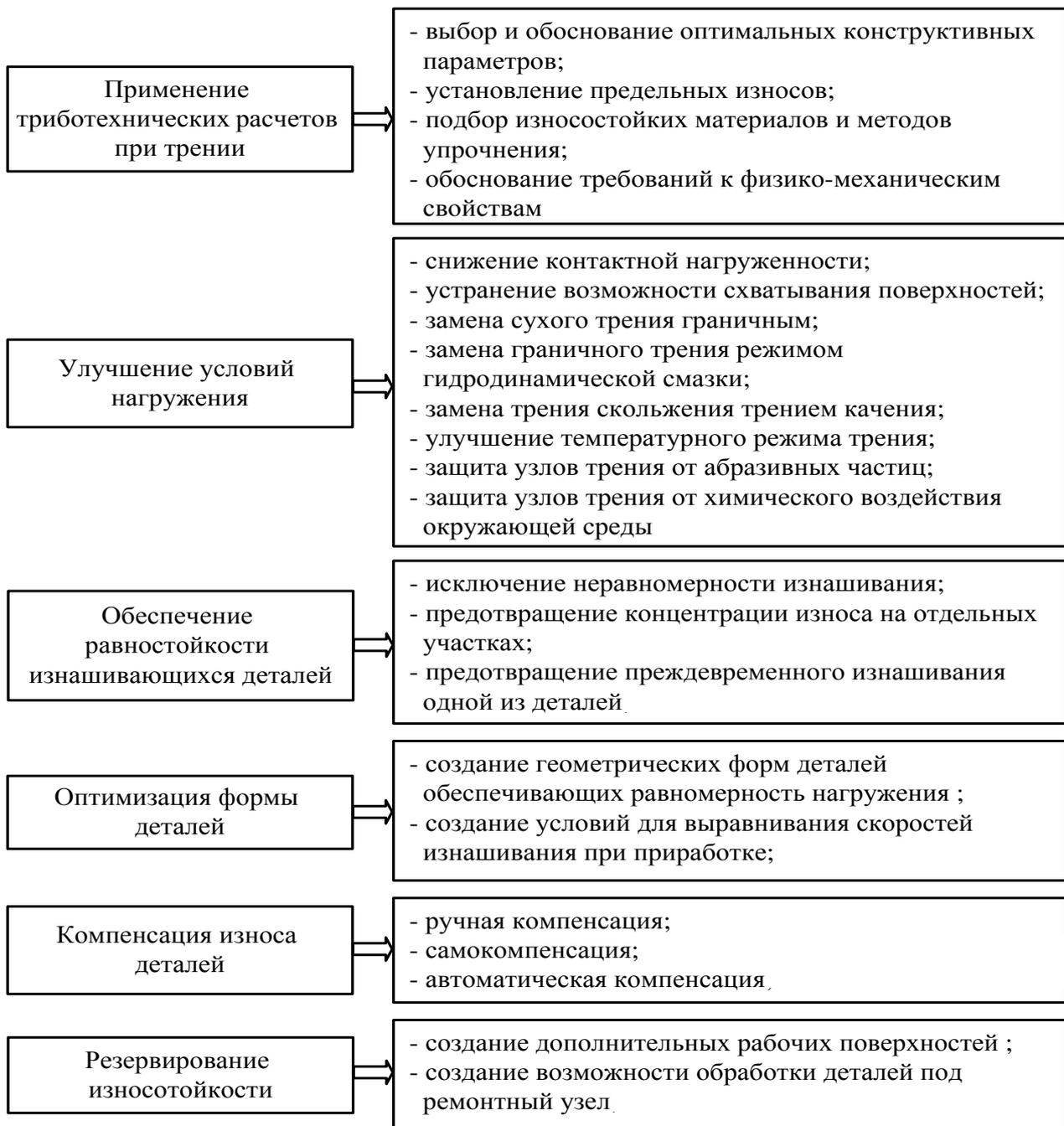
Рис. 7.1. Конструкторские способы улучшения условий трения
