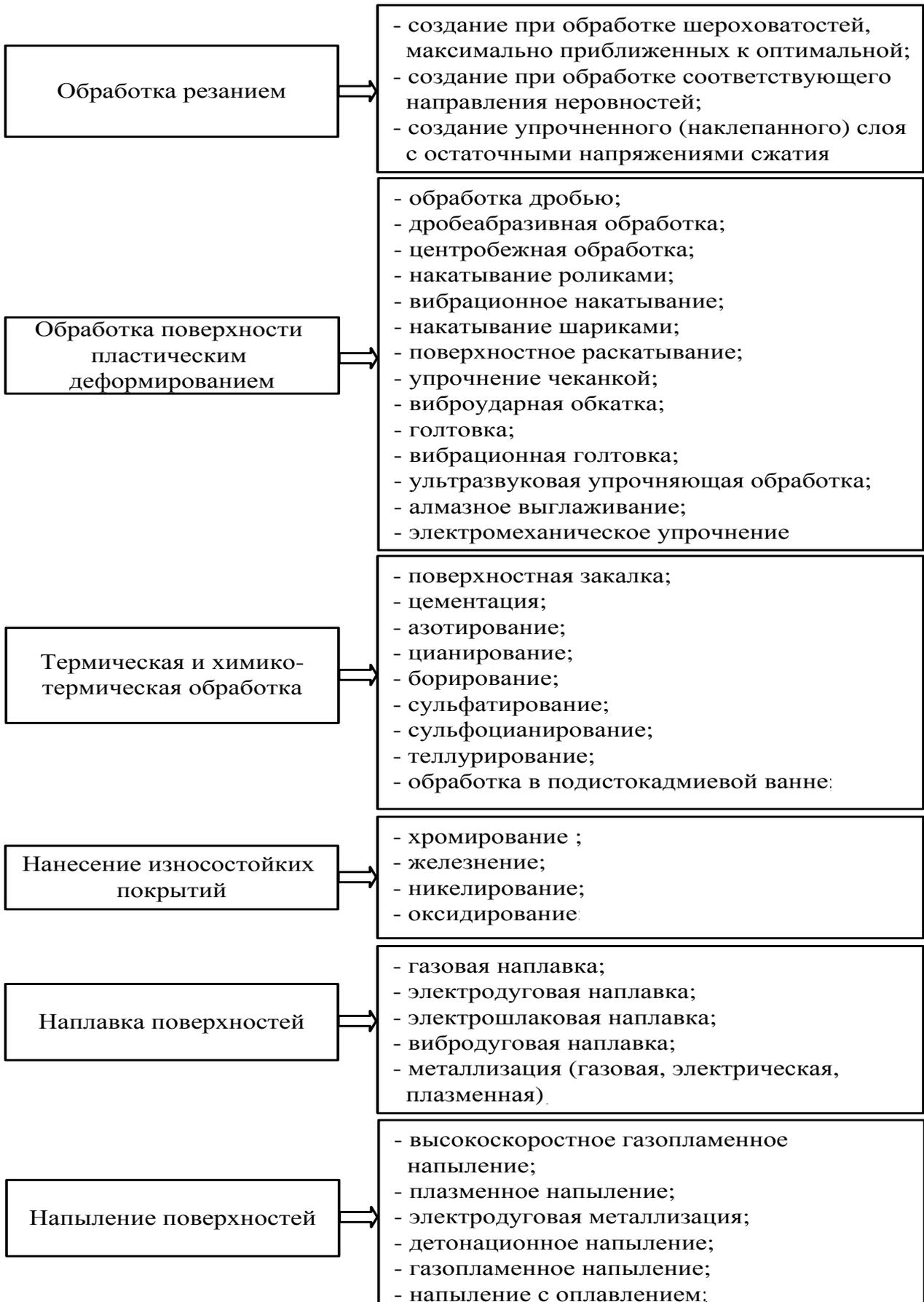
Рис. 7.3. Технологические методы повышения износостойкости узлов трения
