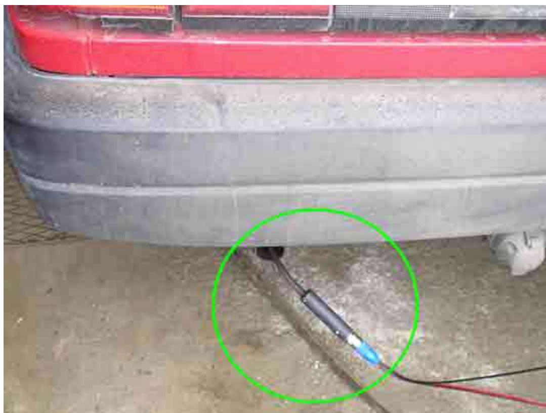
Рисунок 59 – Подключение датчика разрежения к выхлопной трубе
