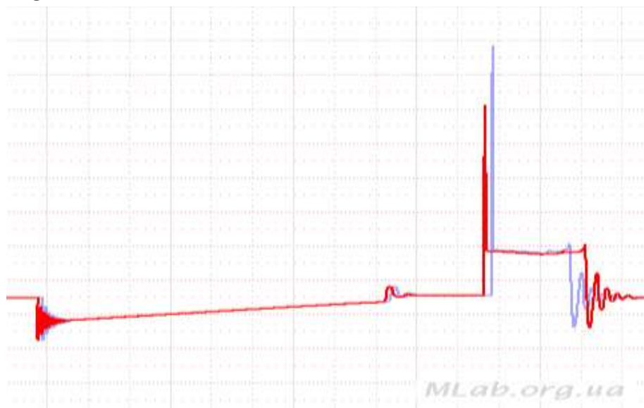
Рисунок 7 – Заниженная компрессия или уменьшение свечного зазора. Неисправность (осциллограмма более темного цвета)
