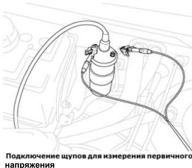
Рисунок 45 – Измерение первичного напряжения в катушке зажигания
