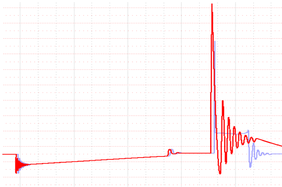
Рисунок 12 – Обрыв ВВ провода (осциллограмма более темного цвета)
