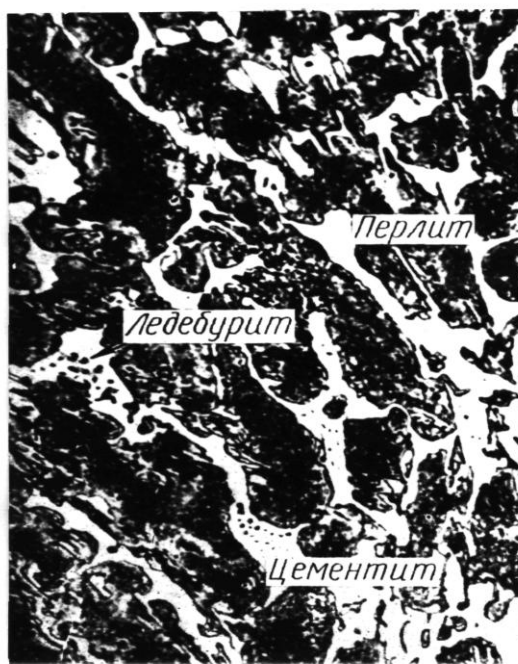
Рис. 15. Микроструктура доэвтектического чугуна, \times 200
