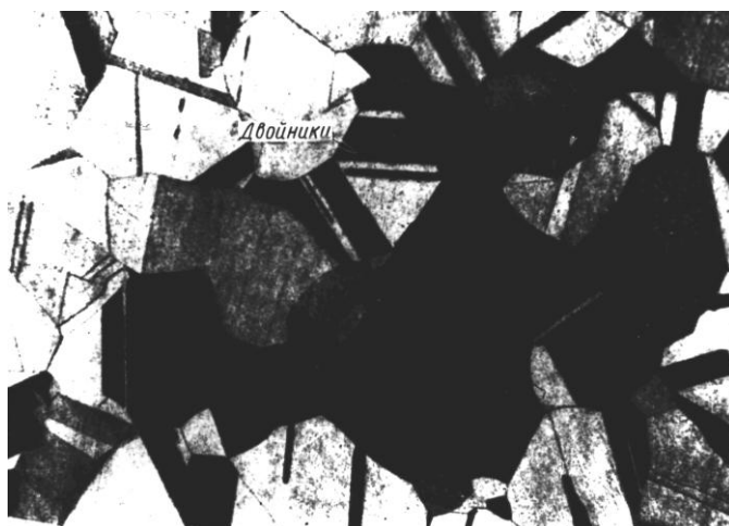
Рис. 43. Микроструктура латуни марки Л68 после деформирования и отжига, \times 250
