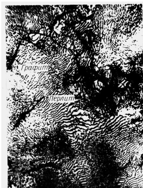
Рис. 18. Микроструктура серого перлитного чугуна, \times 1000
