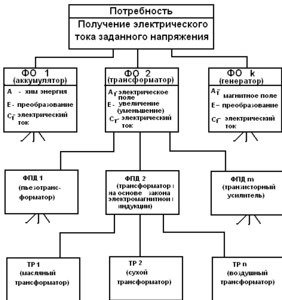
Рисунок 3 - Пример иерархии или систематики технического объекта (ТО)
