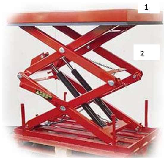
Рисунок 2.8 – Стационарный подъемный стол: 1 – грузовая платформа; 2 – подъемный механизм
