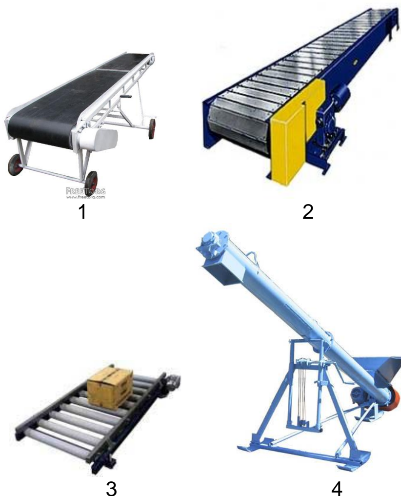
Рисунок 2.10 – Конвейеры: 1 – ленточный; 2 – пластинчатый; 3 – роликовый; 4 – винтовой
