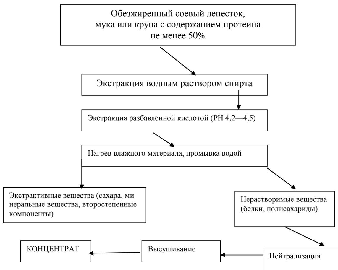
*Рис. 11. Общая схема промышленных способов получения соевых концентратов*
