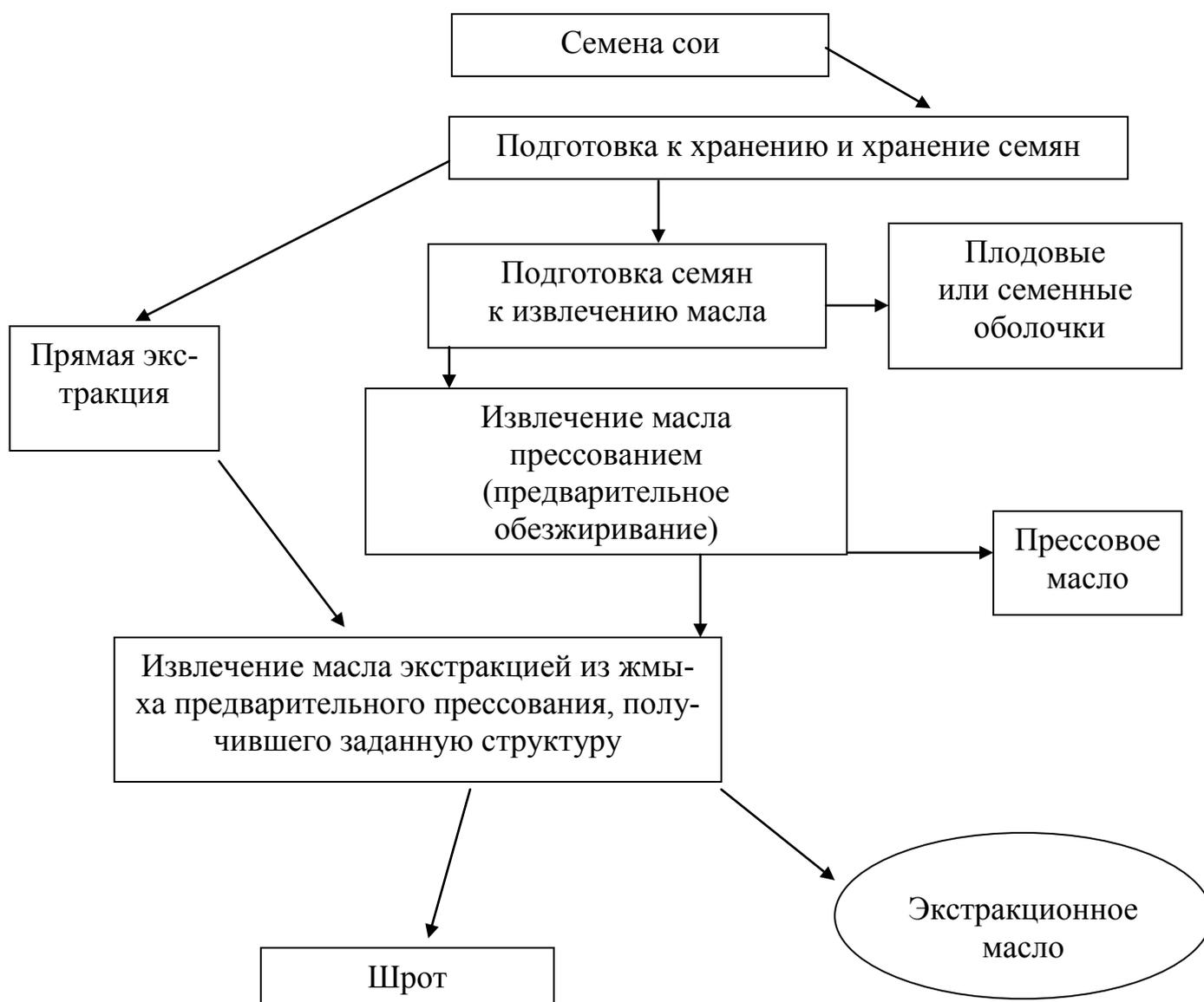
*Рис. 8. Технологическая схема получения соевого масла*
