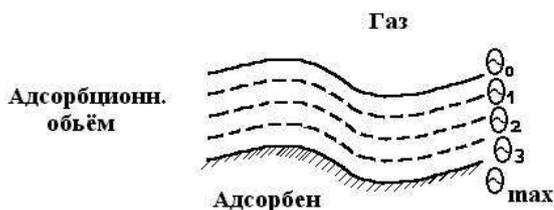
Рис. 1.13. Схема адсорбционного объема
