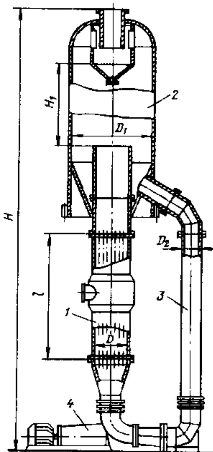
Рисунок Б7 - Выпарной аппарат с принудительной циркуляцией и сосной греющей камерой (тип 2, исполнение 2):
