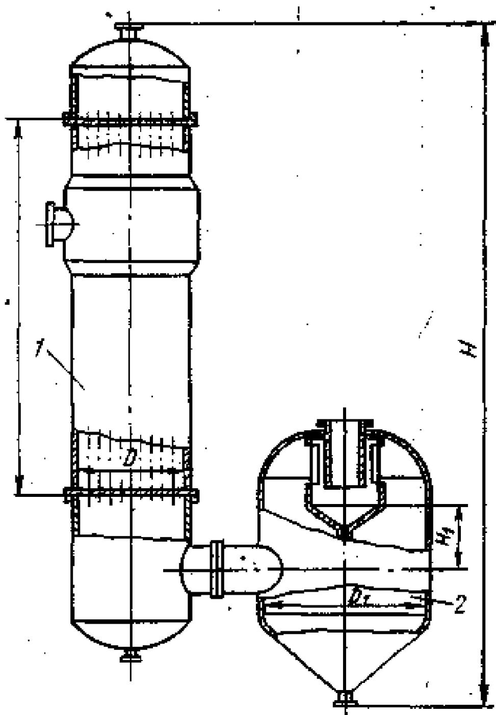
Рисунок Б9 - Выпарной аппарат со стекающей пленкой (тип 3, исполнение 2):
