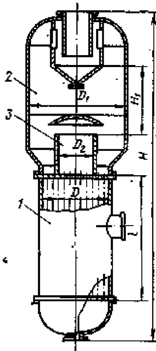
Рисунок БЗ - Выпарной аппарат с естественной циркуляцией и соосной двух-
