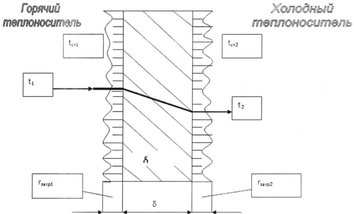
Рисунок 2.1 - Схема процесса теплопередачи
