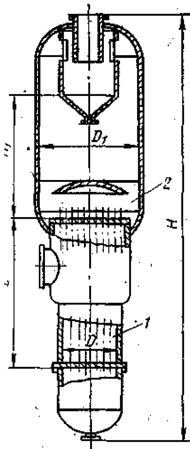
Рисунок Б8 - Выпарной аппарат с восходящей пленкой (тип 3, исполнение 1):
