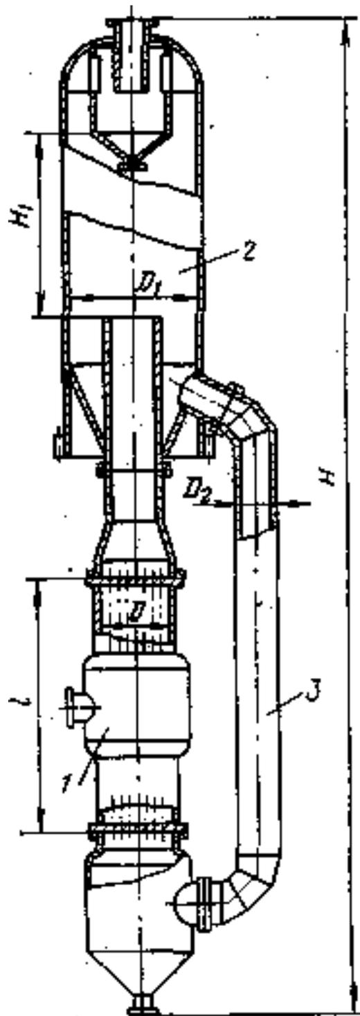
Рисунок Б5 - Выпарной аппарат с естественной циркуляцией, соос-
