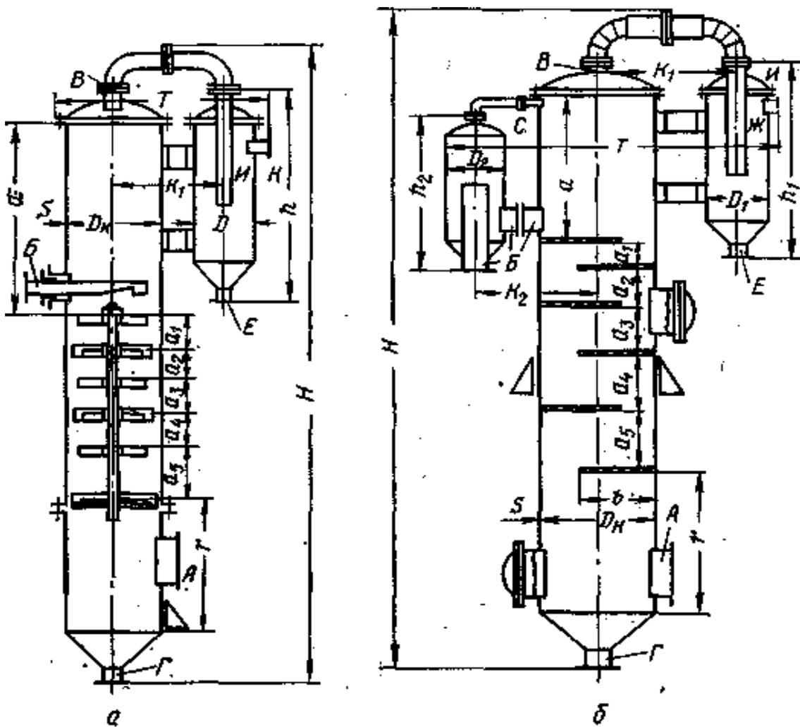
Рисунок Б10 - Барометрические конденсаторы:
