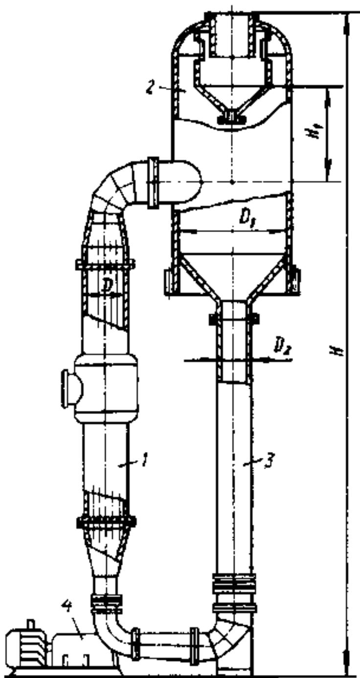
Рисунок Б6 - Выпарной аппарат с принудительной циркуляцией и вынесенной греющей камерой (тип 2, исполнение 1):
