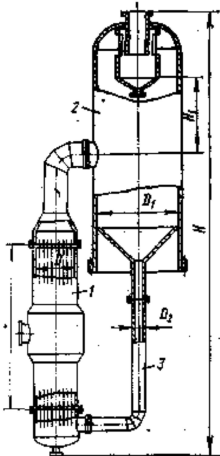
Рисунок Б4 - Выпарной аппарат с естественной циркуляцией и вынесенной греющей камерой (тип 1, исполнение 2):
