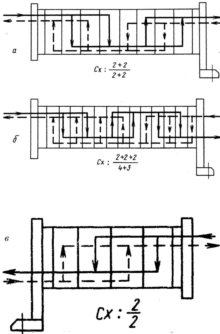
Рисунок Б17 - Примеры компоновки пластин:
