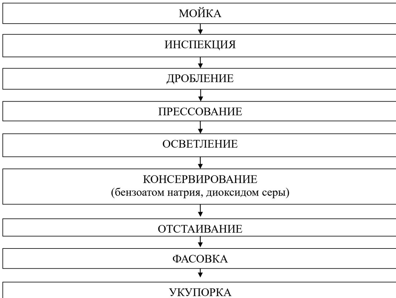
Технологический процесс производства плодово-ягодных соков, концентрированные диоксидом серы или бензоатом:
