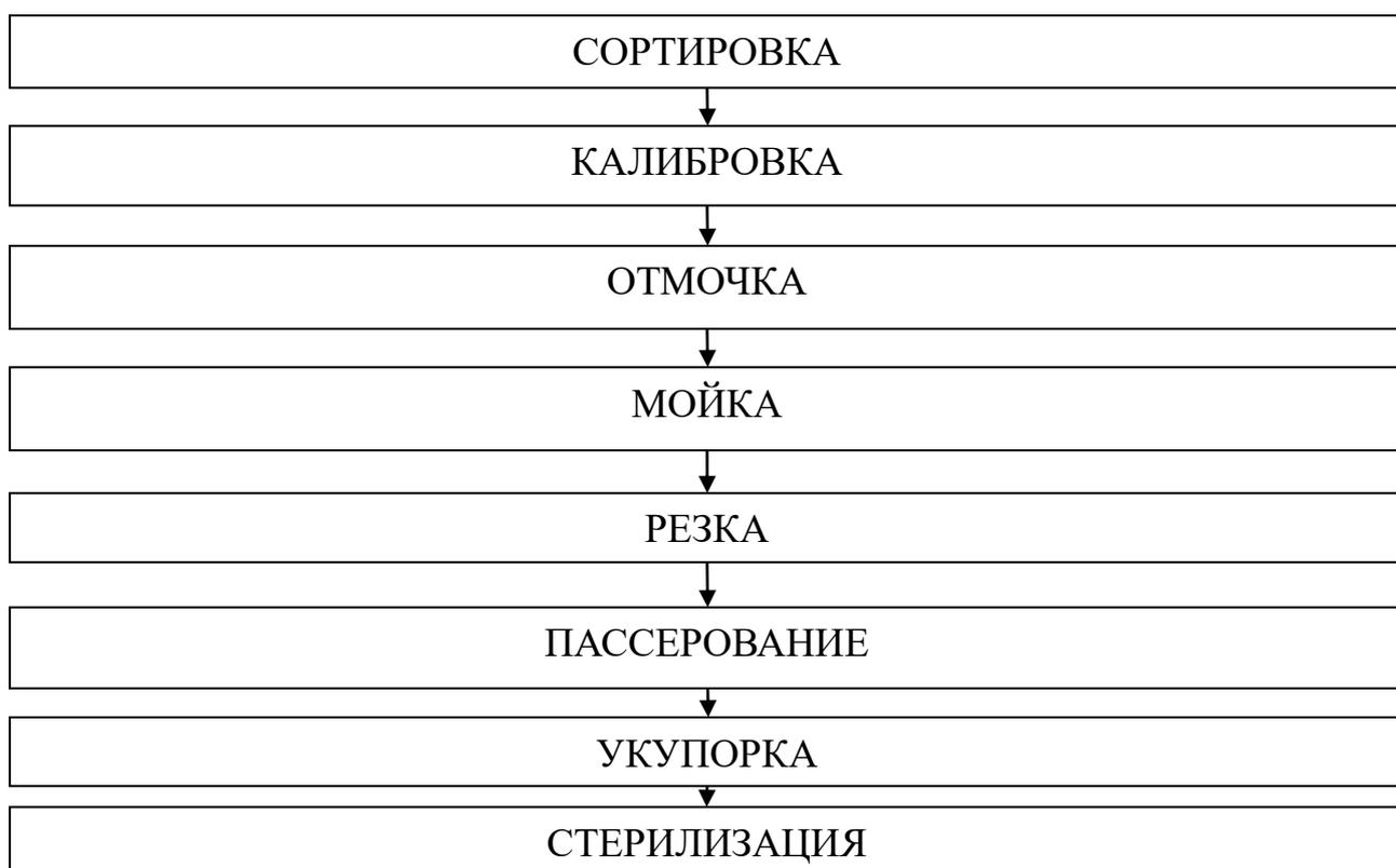
Технологический процесс производства моркови пассированной с томатом (полуфабрикат):
