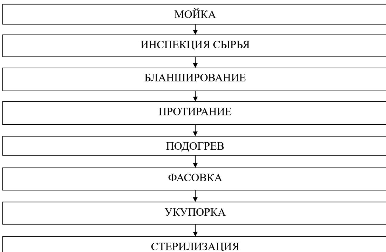
Технологический процесс производства пюре плодово-ягодного стерилизованного:
