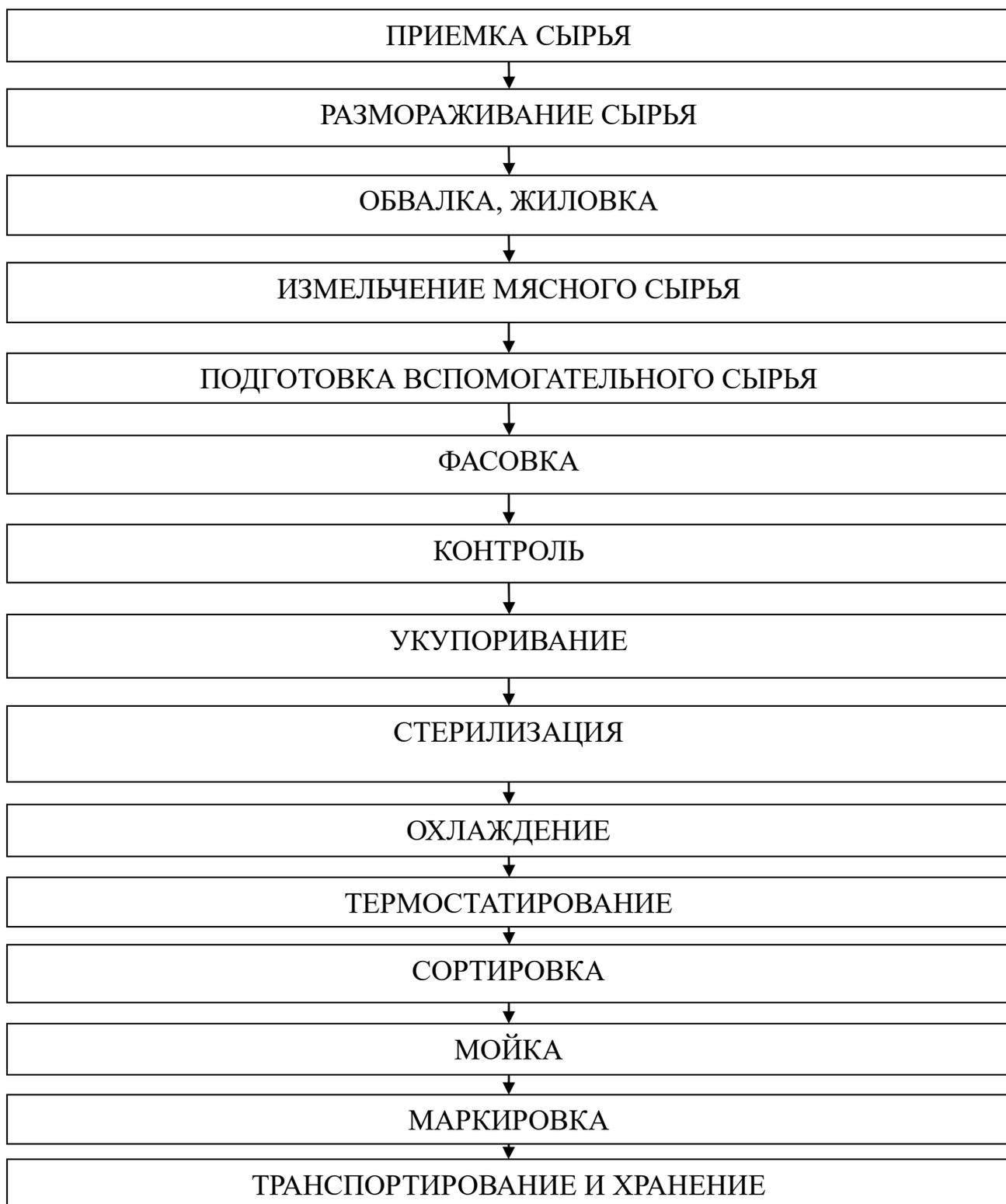
Технологический процесс производства консервов мясных, консервов из мяса цыплят – бройлеров:
