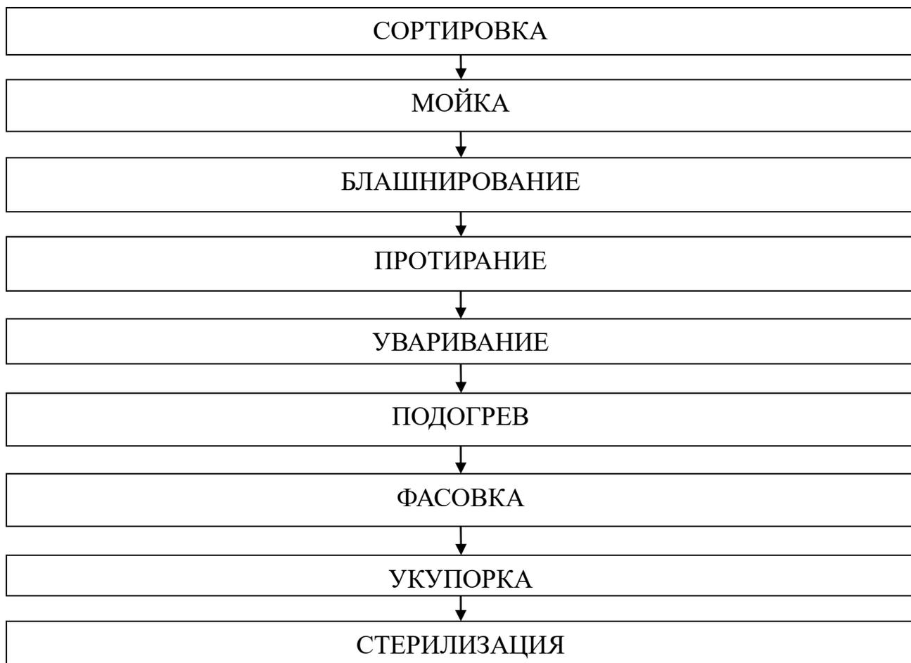
Технологический процесс производства пюре из шпината, пюре из щавеля, пюре из смеси шпината и щавеля:
