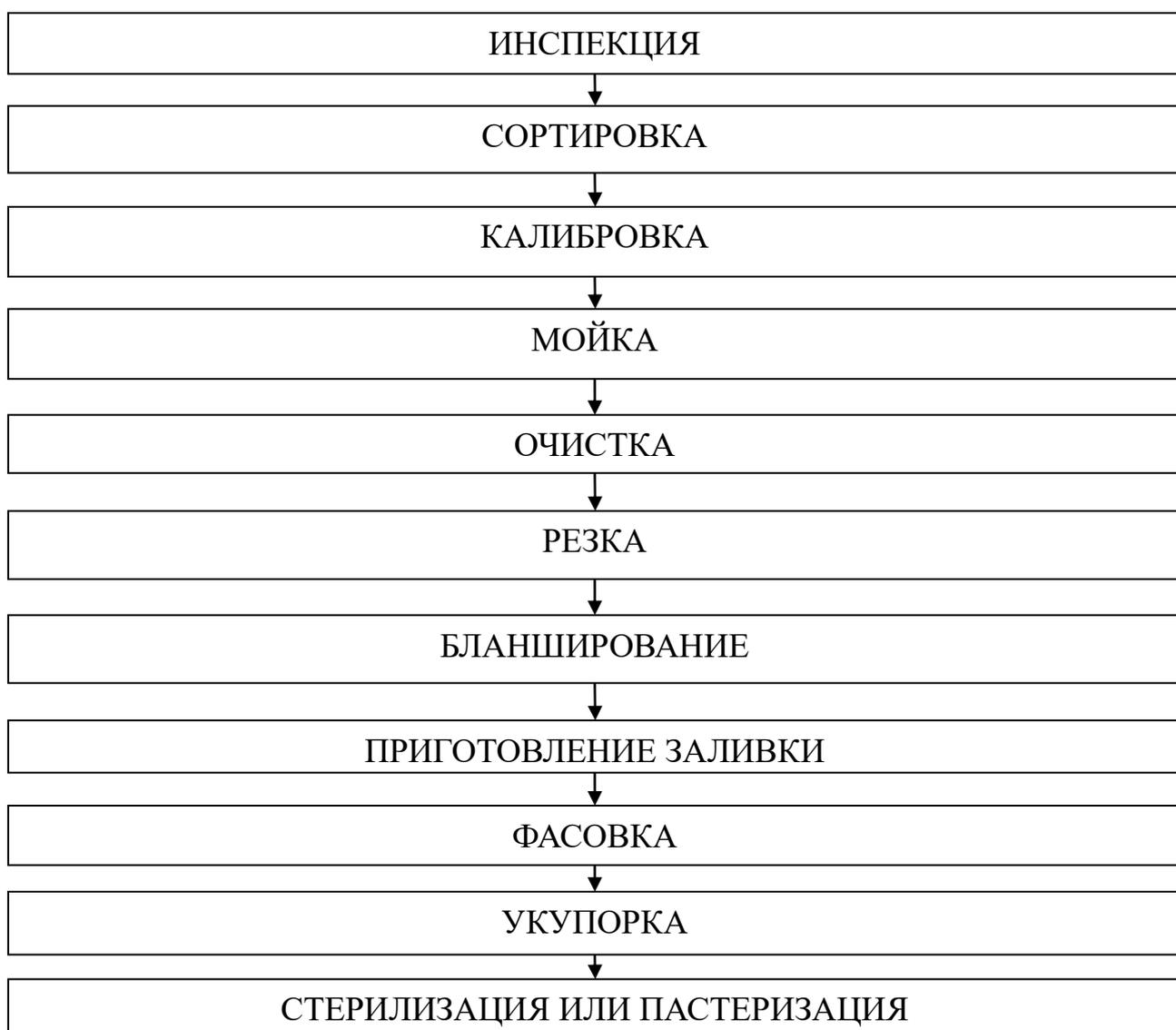
Технологический процесс производства консервированных натуральных плодов:
