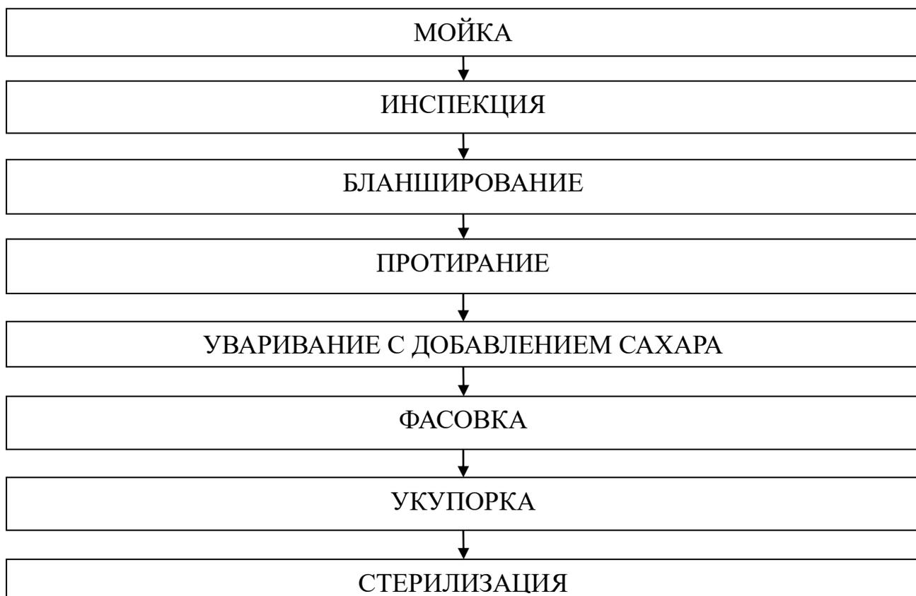
Технологический процесс производства соуса фруктового:
