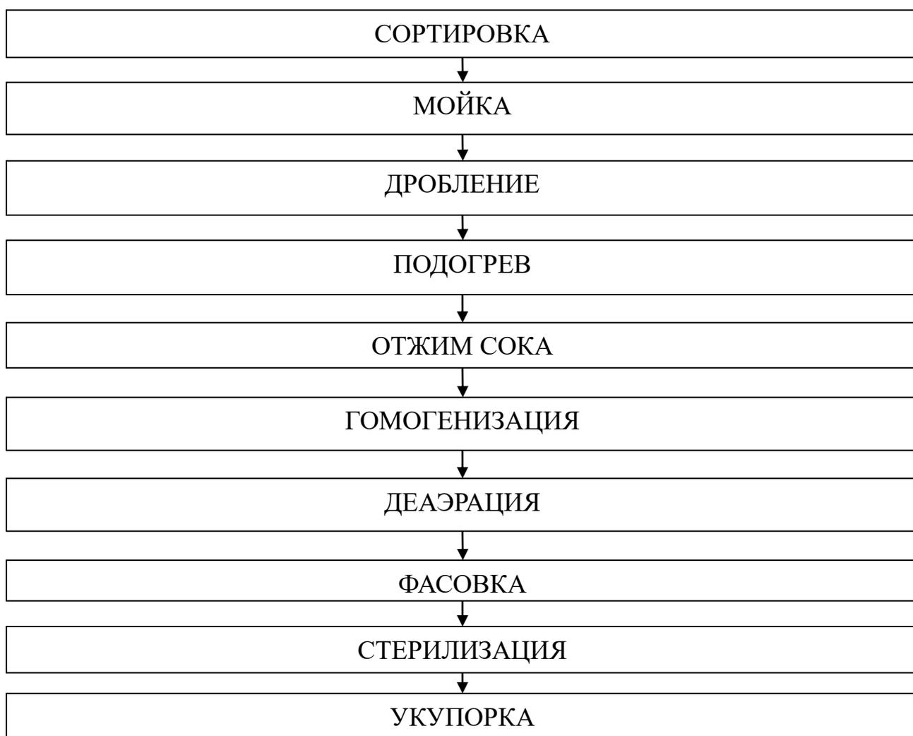
Технологический процесс производства сока томатного:
