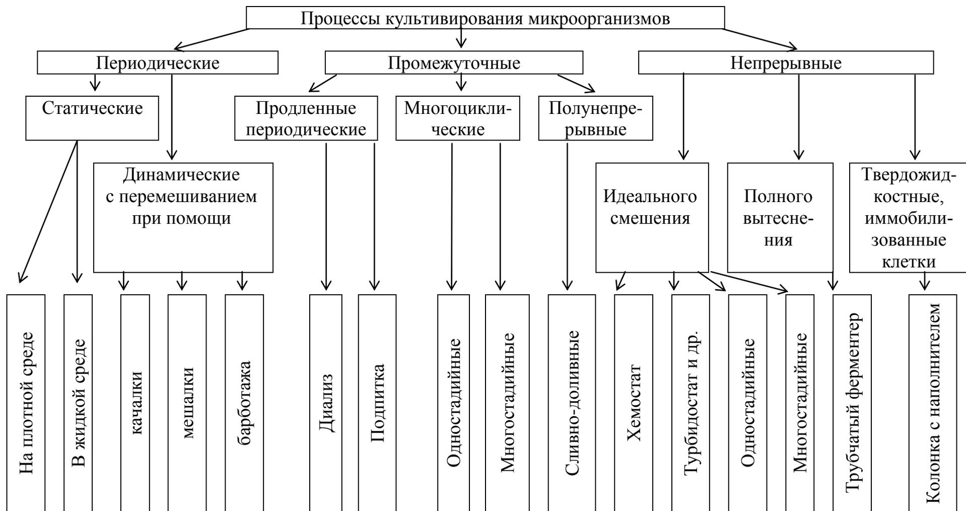
Рис. 36. Классификация процессов культивирования микроорганизмов по способу действия
