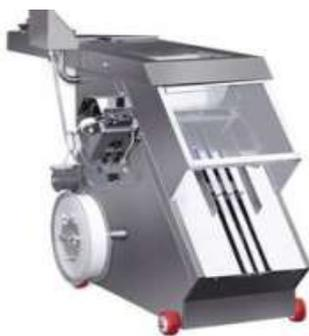
*Рисунок 7.7 – Общий вид клипсатора АТОR-1500*
