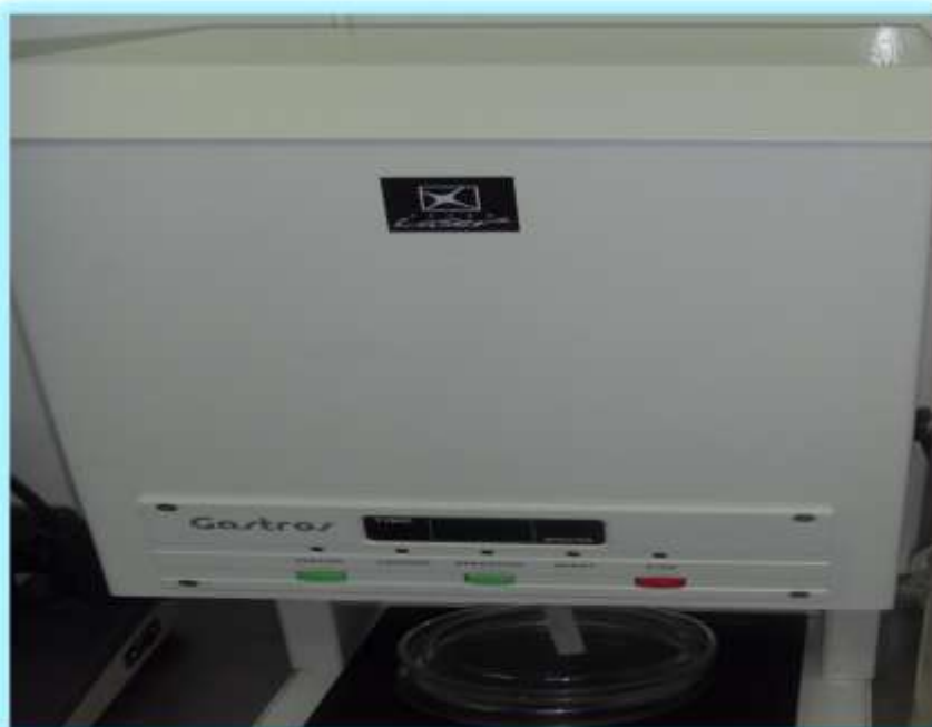
Рис. 5. Аппарат для выделения личинок трихинелл «ГАСТРО»
