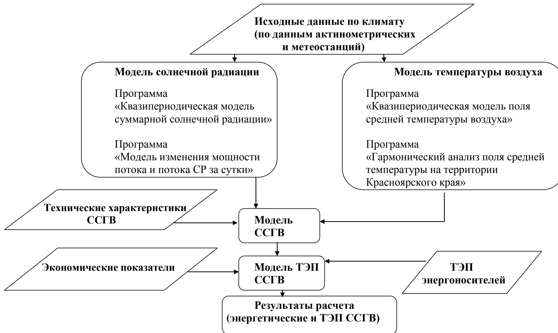
Рисунок 2.1 – Структура моделирования влияния природно-техногенных факторов на режимы работы, энергетическую и экономическую эффективность ССГВ
