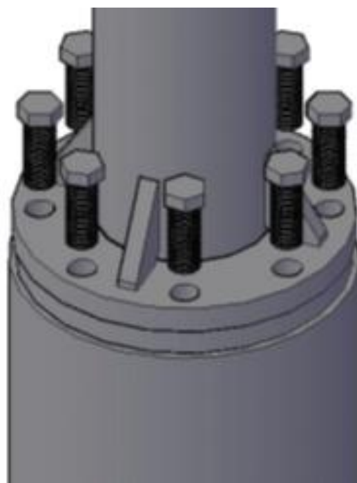
Рисунок 3.15 – Соединение сегментов башни ВЭУ болтами
