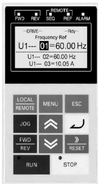
Рис. П Г.2. Внешний вид цифровой панели управления преобразователя частоты
