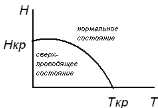
Рис. 3.5. Зависимость критической напряженности магнитного поля сверхпроводника от температуры
