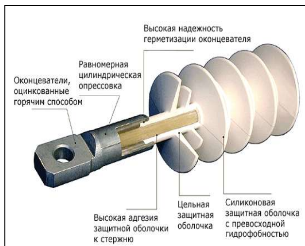
Рис. 2.8. Внешний вид нелинейных ограничителей перенапряжения с полимерными крышками
