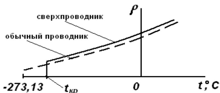
Рис. 3.3. Температурные зависимости удельного сопротивления проводника и сверхпроводника
