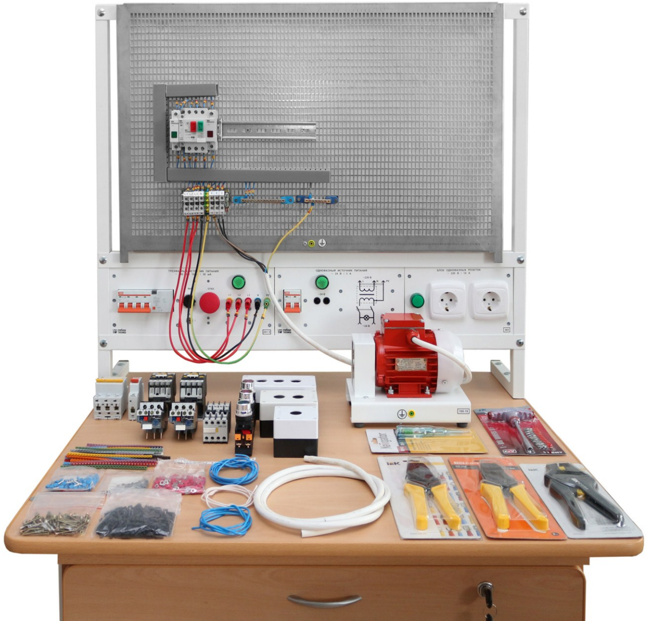
Рисунок 1.1 – Пример смонтированной на электромонтажном столе схемы нереверсивного управления трехфазным асинхронным двигателем с короткозамкнутым ротором с использованием ручного кнопочного пускателя.
