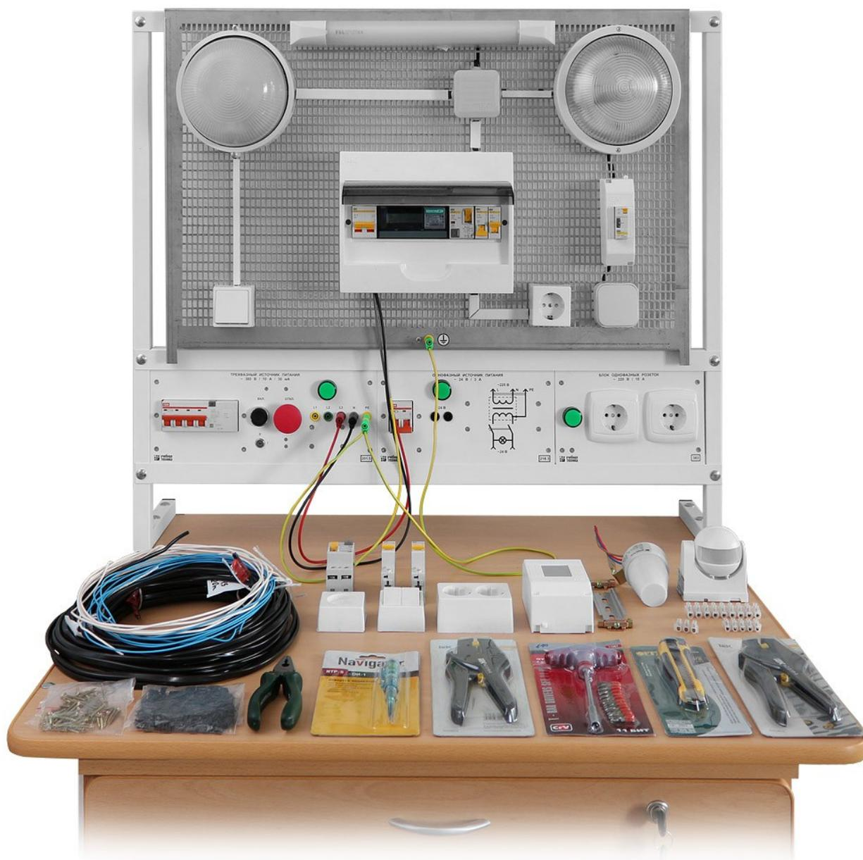
Рисунок 1.— Пример смонтированной на электромонтажном столе групповой электрической сети освещения с таймером и розеток в квартире с системой заземления TN-C-S.
