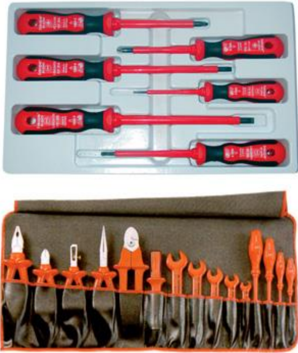
Рис. 6.6. Ручной изолирующий инструмент: а – отвертки; б – комплект изолирующего инструмента
