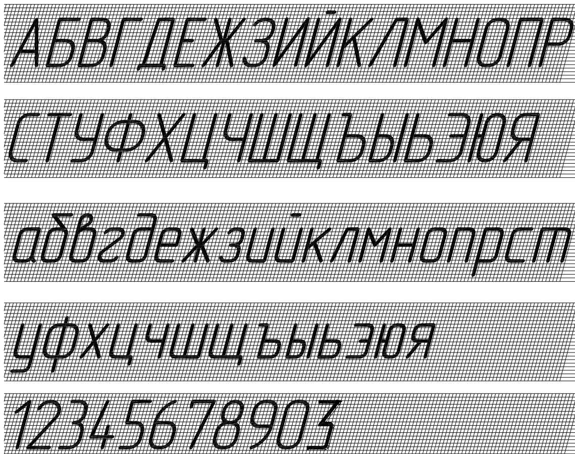
Рисунок 1.7 – Шрифт типа А с наклоном
