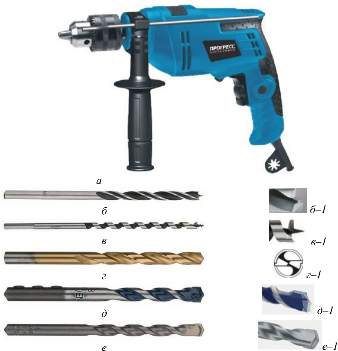
Рис. 1.1. Ударная электрическая дрель и оснастка для сверления [7]: а – дрель электрическая ударная ДЭУ-680 К1 (Россия); б – спиральное сверло по дереву (диаметр сверла D – от 3 до 30 мм, диаметр хвостовика d – от 3 до 13 мм, рабочая длина L1 – от 33 до 145 мм, общая длина L2 – от 61 до 220 мм) [6]; б-1 – заточка спирального сверла по дереву; в – винтовое сверло по дереву ( D – от 6 до 32 мм, хвостовик шестигранный от 4,8 до 11,1 мм, L1 – от 100 до 470 мм, L2 – от 160 до 600 мм); в-1 – заточка винтового сверла по дереву; г – сверло по металлу ( D – от 1 до 13 мм, d – от 1 до 13 мм, L1 – от 12 до 101 мм, L2 – от 34 до 154 мм) [6]; г-1 – заточка сверла по металлу; д – сверло по бетону CYL-5, для сверления в граните, бетоне, кирпичной кладке, ударопрочное высокопроизводительное сверло, для любых ударных дрелей ( D – от 3 до 20 мм, d – от 3 до 10 мм, L1 – от 50 до 140 мм, L2 – от 90 до 200 мм) [6]; д-1 – заточка сверла по бетону CYL-5; е – сверла по бетону CYL-3, для бетона, кирпичной кладки, ударопрочные высокопроизводительные сверла по ISO 5468 для любых ударных дрелей ( D – от 3 до 20 мм, d – от 3 до 12,3 мм, L1 – от 40 до 550 мм, L2 – от 70 до 600 мм) [6]
