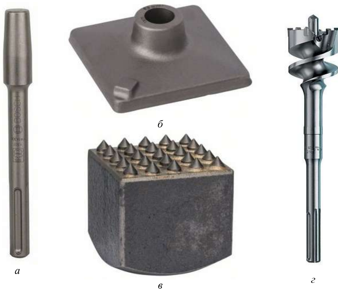
Рис. 1.8. Насадки SDS-max для перфораторов тяжелого класса: а – зажим для отбойных и трамбовочных пластин (L2 – 220 мм); б – трамбовочная пластина (120 × 120 мм или 150 × 150 мм); в – твердосплавная отбойная пластина (50 × 50 мм, количество твердосплавных зубьев 5 × 5 шт.); г – фреза для бетона Drebo SDS-max (d – от 40 до 80 мм, L2 – от 310 до 990 мм) [9]
