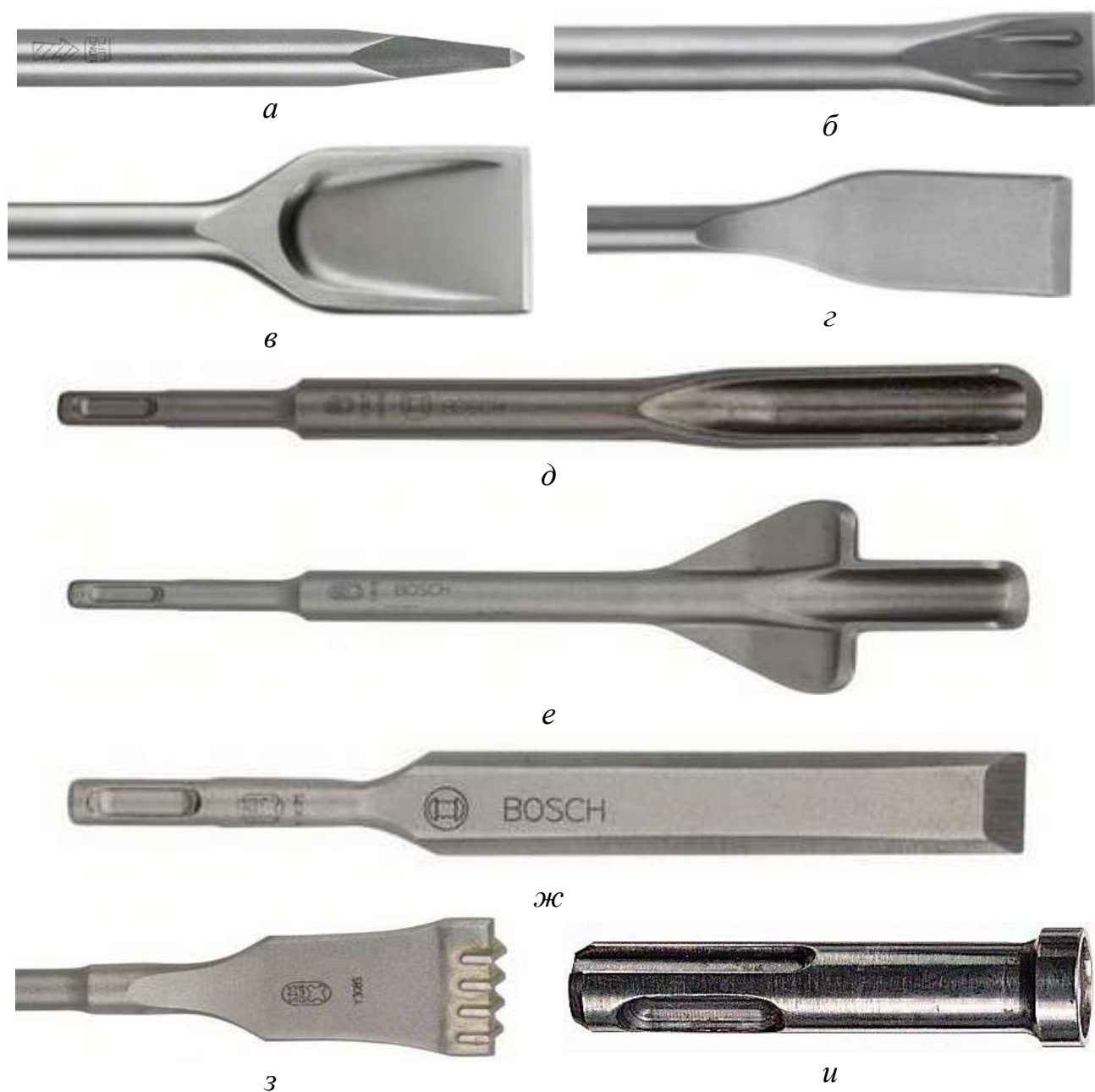
Рис. 1.4. Ударные насадки с хвостовиком SDS-plus: а – пикообразное зубило; б – плоское зубило; в – лопаточное зубило; г – зубило для снятия керамической плитки; д – полукруглое зубило; е – зубило с отвалом/канальное зубило; ж – долото (стамеска); з – стыковое зубило с твердосплавными вставками; и – костыльная кувалда
