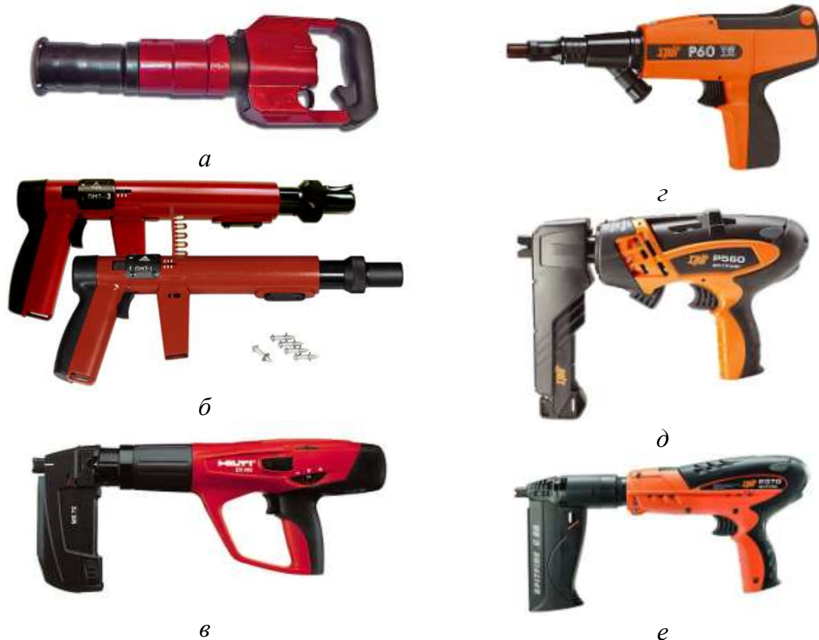
Рис. 1.10. Пороховой инструмент Российского и зарубежного производства: а – пороховой монтажный пистолет ПЦ-84; б – пороховые монтажные пистолеты ПМТ-3 и ПМТ-1; в – автоматический строительный пистолет Hilti DX 460 MX; г – пороховой строительный пистолет Spit P60; д – автоматический строительный пистолет Spit P560, е – автоматический строительный пистолет Spit P560 [11]
