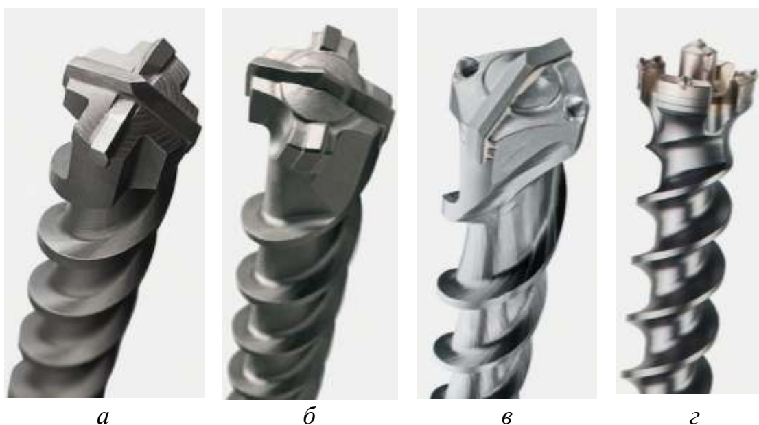
Рис. 1.6. Насадки для перфоратора с хвостовиком SDS-max фирмы Bosch для ударного сверления [6]: а – ударное сверло SDS-max-4, для неармированного и армированного бетона, кирпичной кладки ( d – от 16 до 40 мм, L1 – от 200 до 400 мм, L2 – от 340 до 540 мм); б – ударное сверло SDS-max-7, для неармированного и армированного бетона, силикатного кирпича, кирпичной кладки ( d – от 12 до 52 мм, L1 – от 200 до 1200 мм, L2 – от 340 до 1340 мм); в – ударное сверло SDS-max-9 NaturalStone, для обработки натурального камня ( d – от 28 до 32 мм, L1 – от 400 до 800 мм, L2 – от 520 до 920 мм); г – ударное сверло SDS-max-9 BreakThrough, для отверстий \varnothing 45–80 мм в бетоне, кирпичной кладке и силикатном кирпиче, например для внешних подсоединений кабелей и трубопроводов (цельное сверло с колоколообразной формой сверлильной головки с асимметрично расположенными твердосплавными вставками и центрирующей твердосплавной режущей пластиной, большая подающая спираль, конический хвостовик) ( d – от 45 до 80 мм, L1 – от 400 до 800 мм, L2 – от 600 до 1000 мм)
