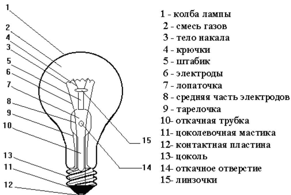
Рисунок 4.1 – Устройство лампы накаливания
