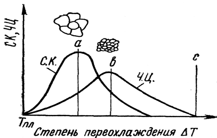
Рис. 16. Зависимость скорости роста кристаллов (с. к.) и скорости зарождения центров кристаллизации (ч. ц.) от степени переохлаждения
