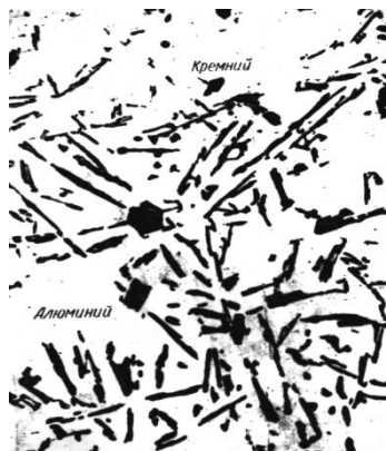
Рис. 80. Микроструктура литейного алюминиевого сплава марки АК12 до модифицирования, \times 200
