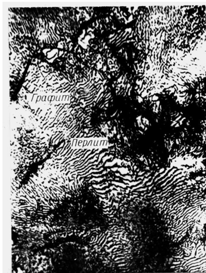
Рис. 50. Микроструктура серого перлитного чугуна, × 1000
