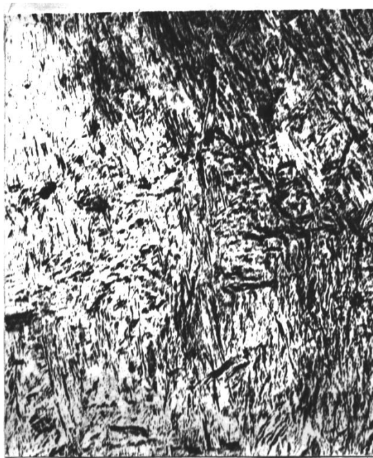
Рис. 57. Микроструктура закаленной стали (мартенсит), \times 500
