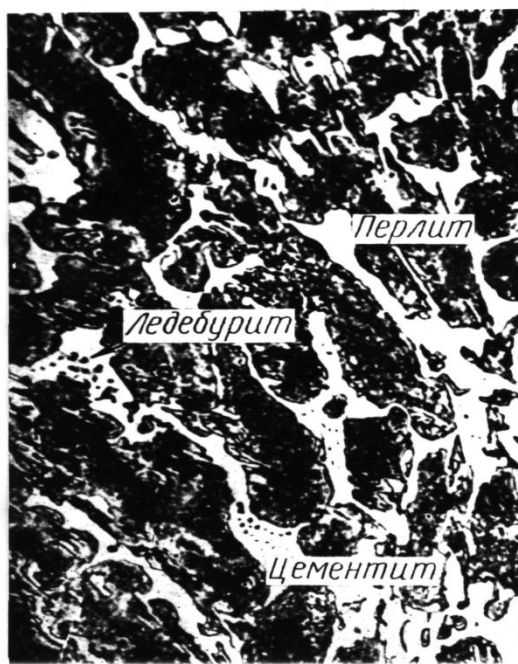
Рис. 47. Микроструктура доэвтектического чугуна, \times 200
