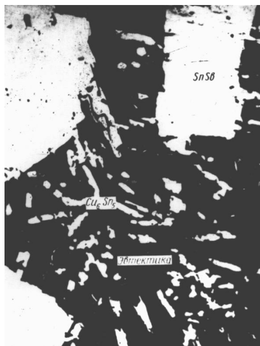
Рис. 83. Микроструктура оловянистого баббита марки Б83, \times 100
