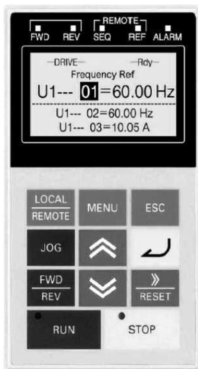
*Рис. Г2. Внешний вид цифровой панель управления преобразователя частоты*
