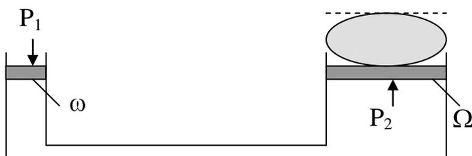
Рис. 2.1. Гидравлический пресс
