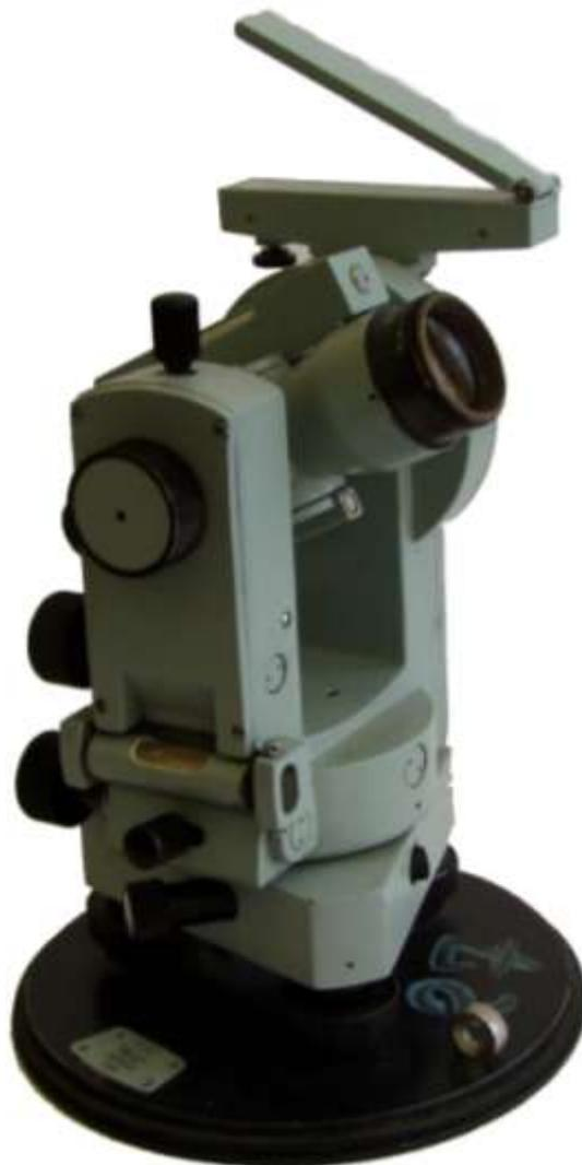
*Рисунок 2 – Оптический теодолит 2Т30П*
