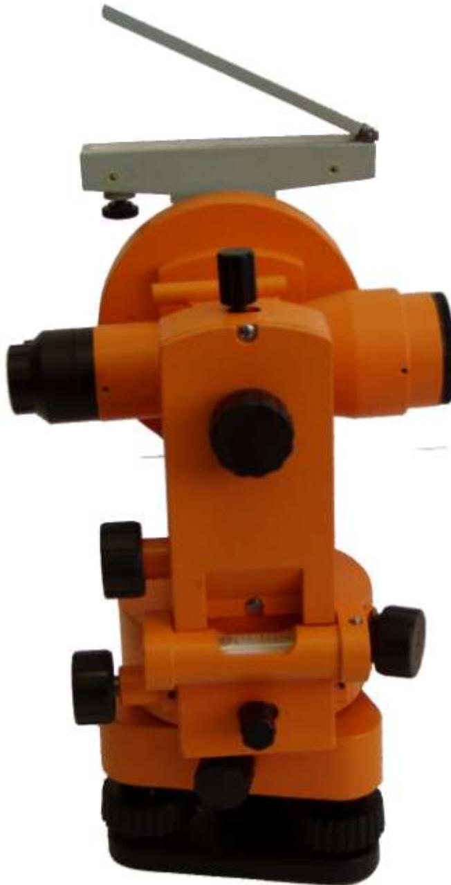
*Рисунок 3 – Оптический теодолит 4Т30П*
