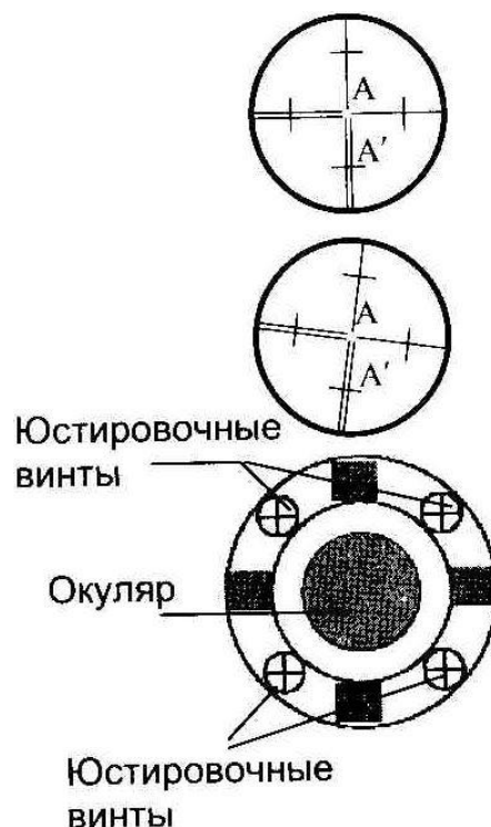
Рисунок 20 – Юстировочные винты сетки нитей
