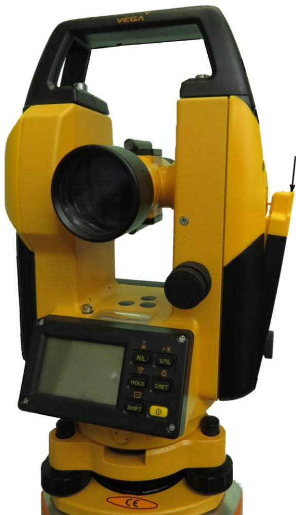
Рисунок 7 – Извлечение аккумуляторного блока (стрелкой отмечена защелка)
