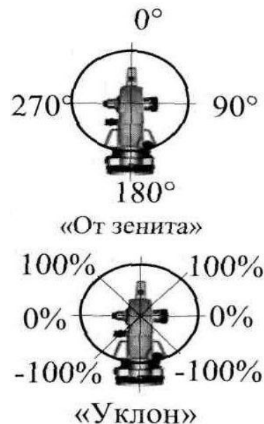
Рисунок 25 – Диапазоны измерения вертикального угла
