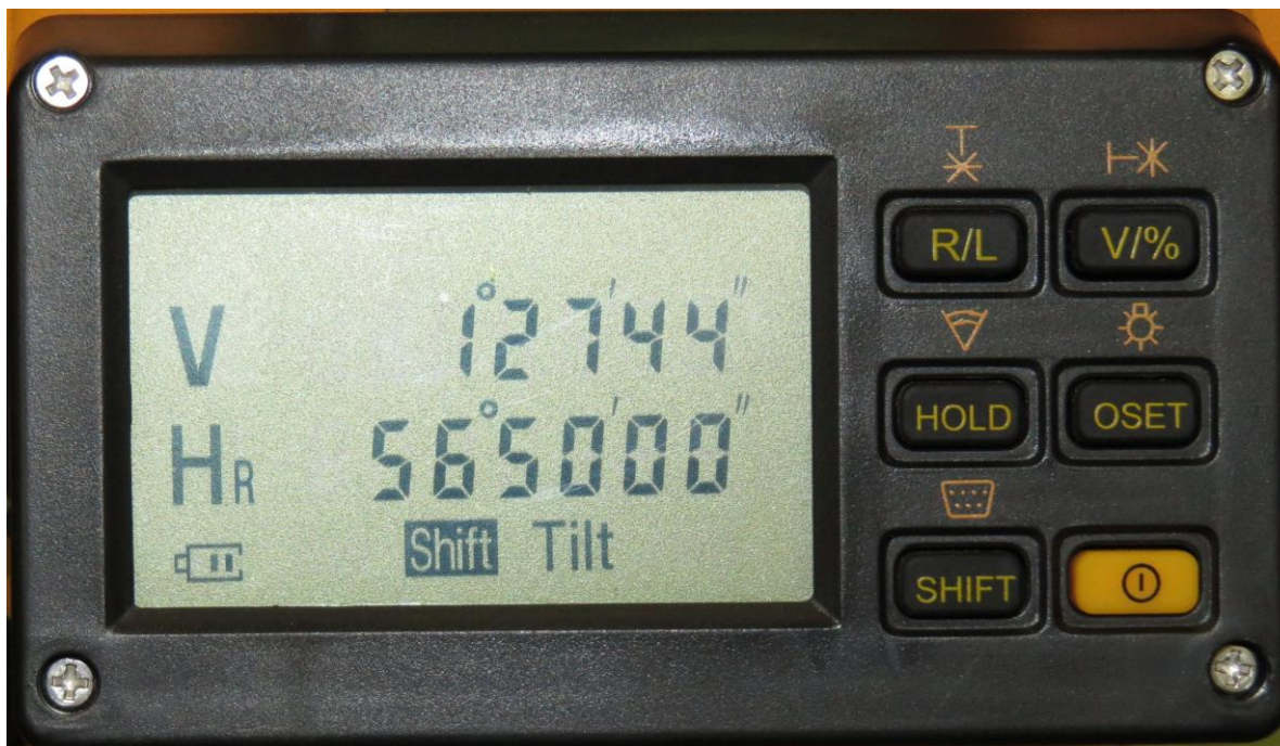
Рисунок 5 – Внешний вид панели управления электронного теодолита VEGA TEO-5B
