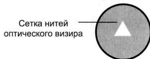
Рисунок 17 – Оптический коллиматорный визир
