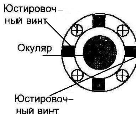
Рисунок 21 – Юстировочные винты сетки (коллимационная ошибка)
