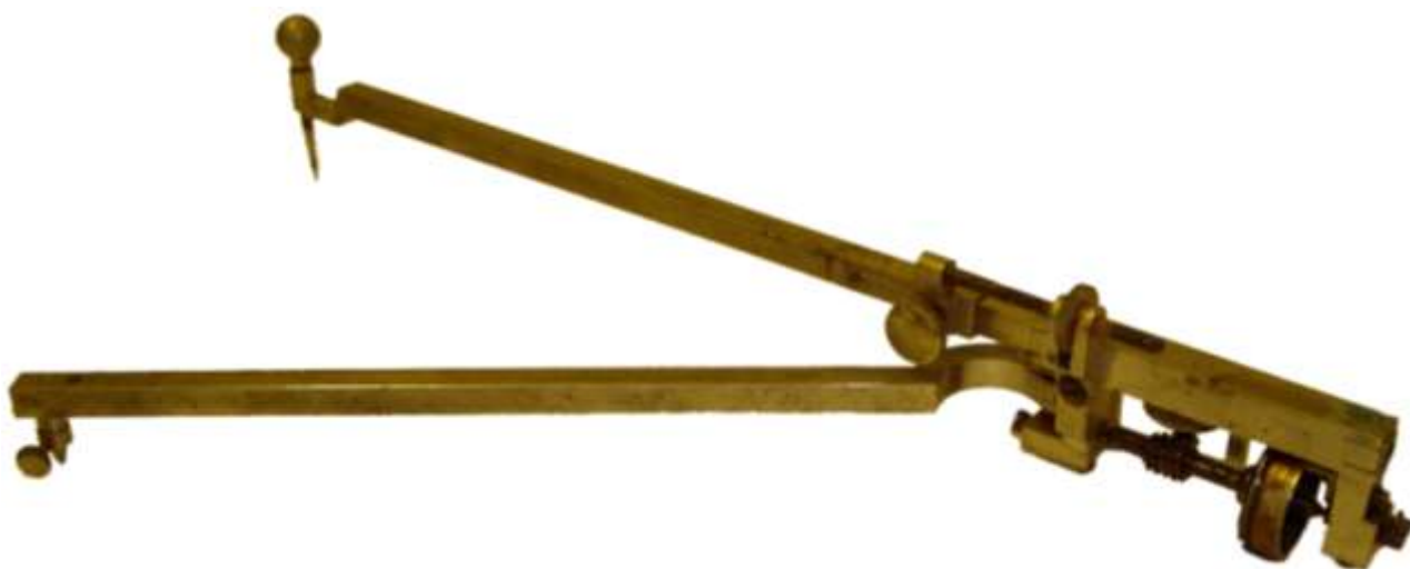
Рисунок 6 – Полярный планиметр Амслера
