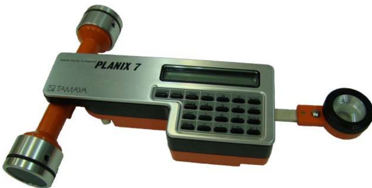
Рисунок 5 – Линейный планиметр PLANIX 7
