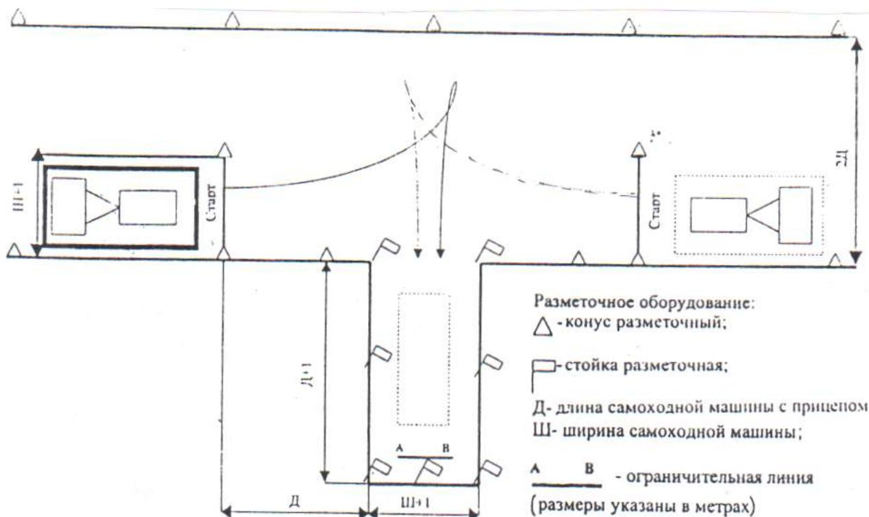
Рисунок П. 7 – Постановка самоходной машины в агрегате с прицепом в бокс задним ходом
