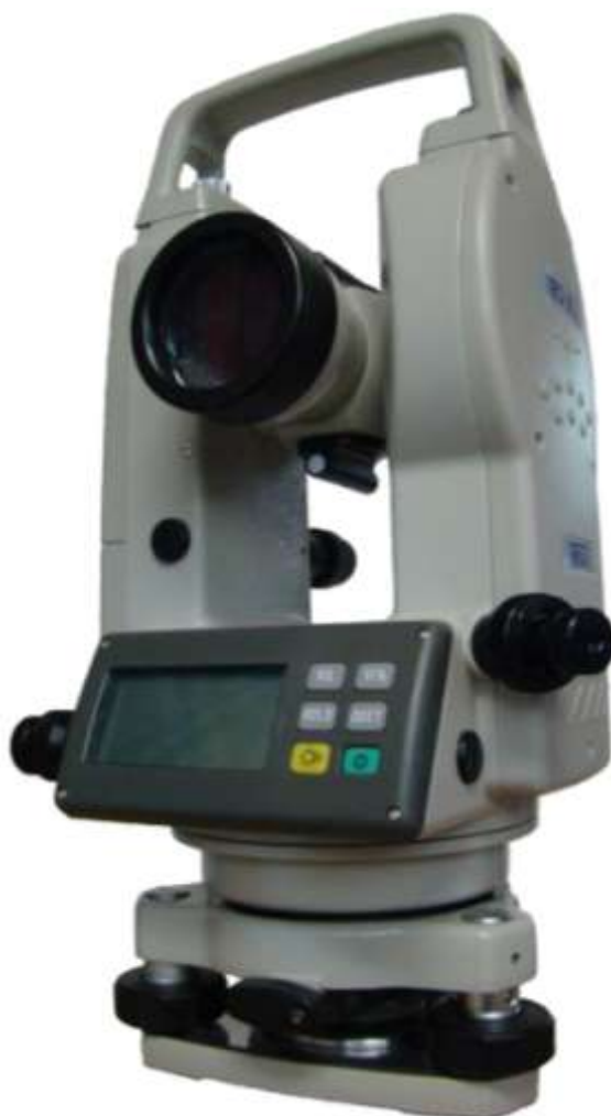
Рисунок 2 – Электронный теодолит VEGA TEO 5
