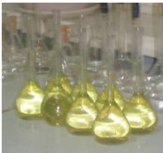
Рисунок 10 – Готовый раствор в мерных колбах на 50 мл для определения содержания фосфора в кормах
