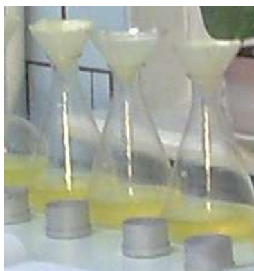
Рисунок 12 – Промывание осадка в фильтре при определении содержания «сырой» клетчатки в кормах
