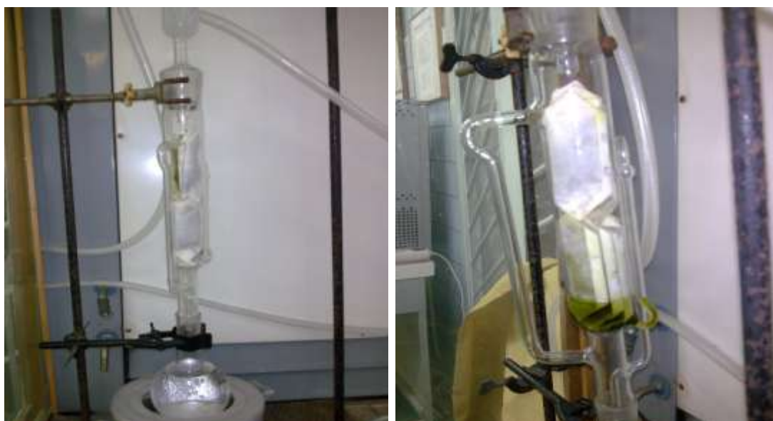
Рисунок 15 – Пакетики с кормом в экстракторе аппарата Сокслета
