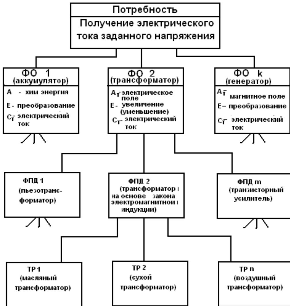
Рисунок 3 – Пример иерархии или систематики технического объекта
