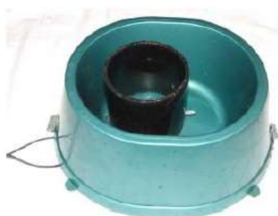
Рисунок 10.21 – Электрообогреваемая открытая, утепленная автономная поилка емкостью 1,5 л конструкции ГНУ НИИПЗК
